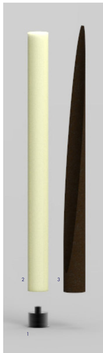
Fig.47 - Representação em 3D da vista explodida do candeeiro de pé
