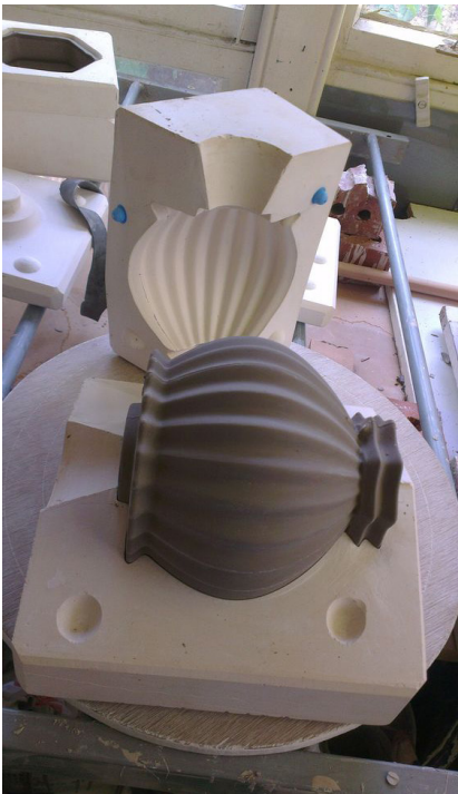
Fig.29 - Técnica de enchimento de peças por molde utilizada na cerâmica.
