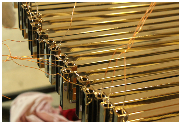
Fig.23 - Peças galvanizadas com acabamento a níquel.
