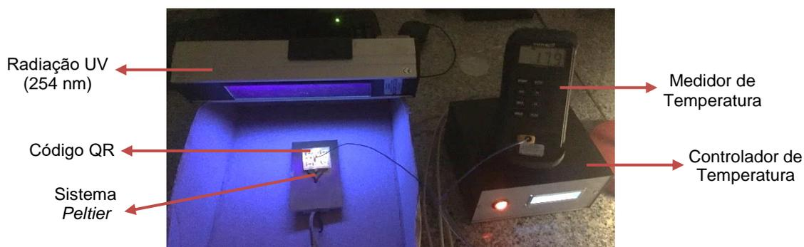
Figura 5.6 – Fotografia da montagem experimental para testar o código QR como sensor de temperatura.
