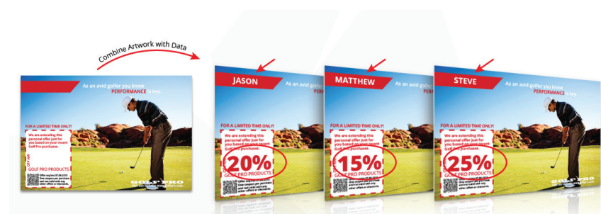
figura 13: amostra de como os dados variáveis são aplicados quando impressos. Fonte: http://www.printingservices.net/vdata.html
