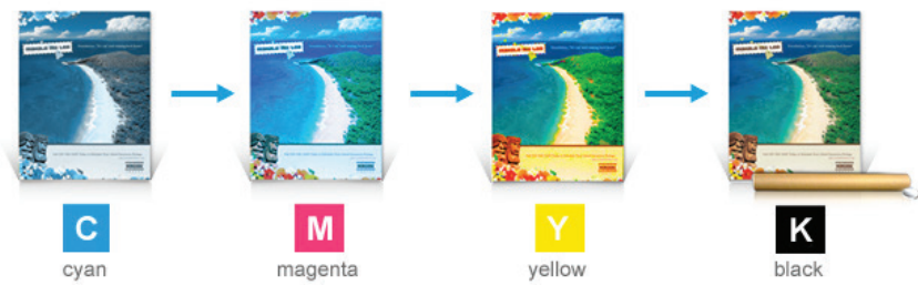
figura 7: exemplo de aplicação de cores na tecnologia de impressão offset. Fonte: https://www.uprinting.com/offset-printing.html
