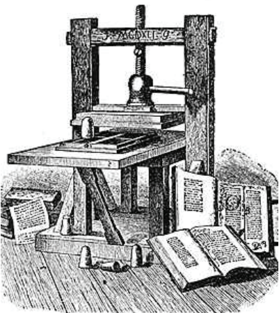
figura 3: prensa de tipos móveis de Gutenberg, adaptada para impressão em larga escala de imagens, mapas, diagramas e tabelas matemática. Fonte: http://homeschoolingkiwiivstyle.blogspot.pt/2009/10/gutenbergs-printing-press.html
