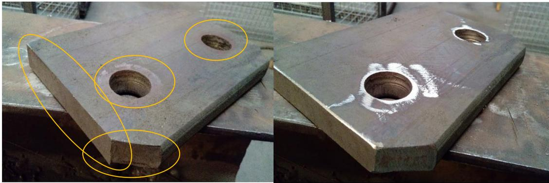
Figura 7 – Exemplo de peça antes e depois de aligeirar arestas e eliminar rebarbas
