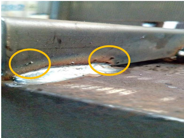
Figura 5 – Exemplo de solda com respingos na envolvente
