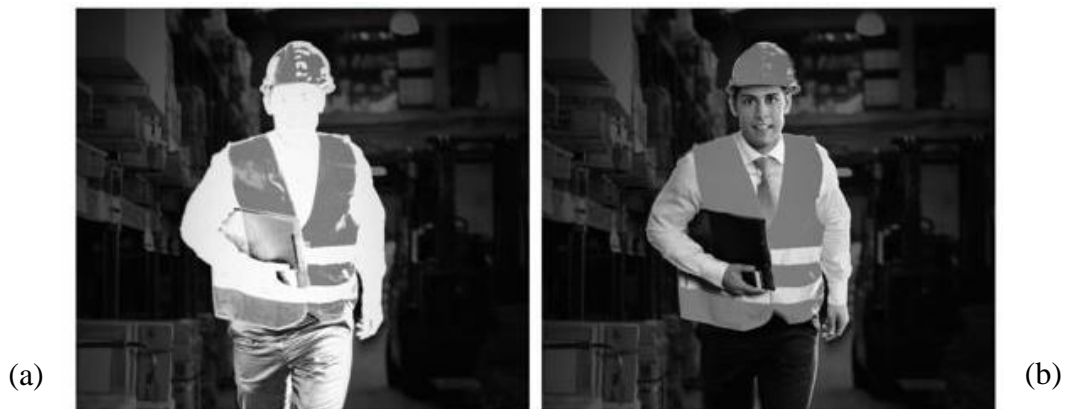
Joonis 13: (a) Tavaline infrapunakaamera; (b) Nutikas infrapunakaamera
