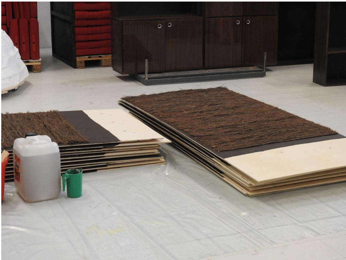
Pooleliolevad kanarbikumatiga kaetud seinapaneelid. Foto autori erakogust
