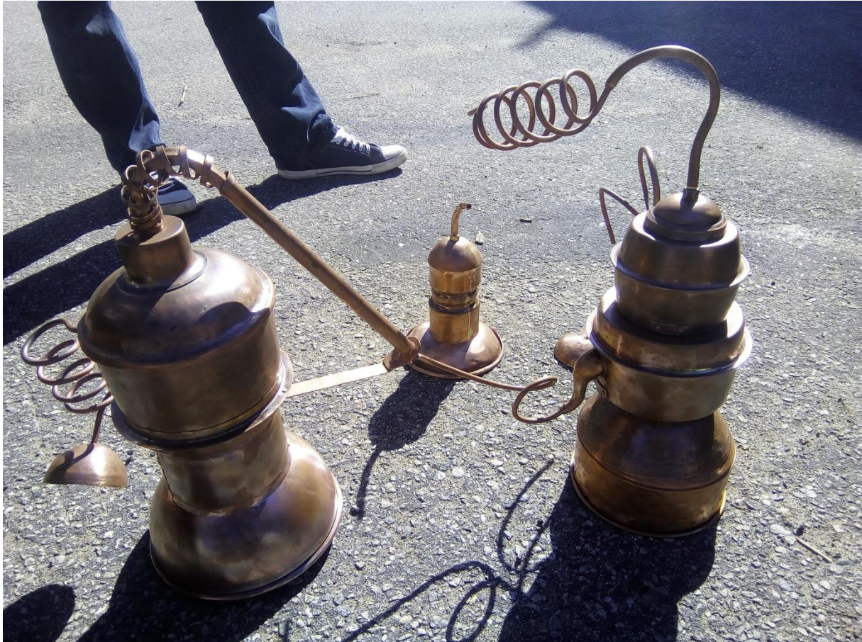
Kokku pandud destillaatori konstruktsioon. Foto autori erakogust
