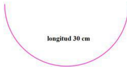
Figura 5. Sección transversal correspondiente a un canalón semicircular.
