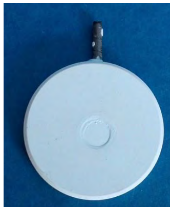
Figure 124 – Système barrière thermique EBPVD endommagé puis réparé par électrophorèse ( U = 100 \text{ V} / 5 \text{ minutes} ) à partir du mélange 50/50, avec une concentration en particules \text{YSZ}_{\text{TZ-8Y}} de 10 g/L et après traitement thermique à 1100 \text{ }^\circ\text{C}
