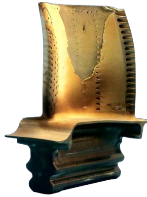
Figure 18 – Photographie d'une aube de turbine HP (M-88) après interaction en service avec les CMAS
