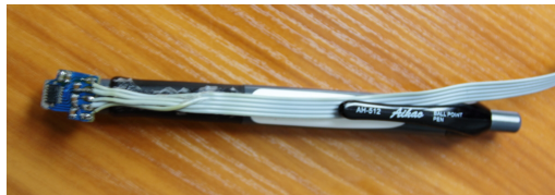
2.1. ábra. Gyorsulásmérővel ellátott golyóstoll
