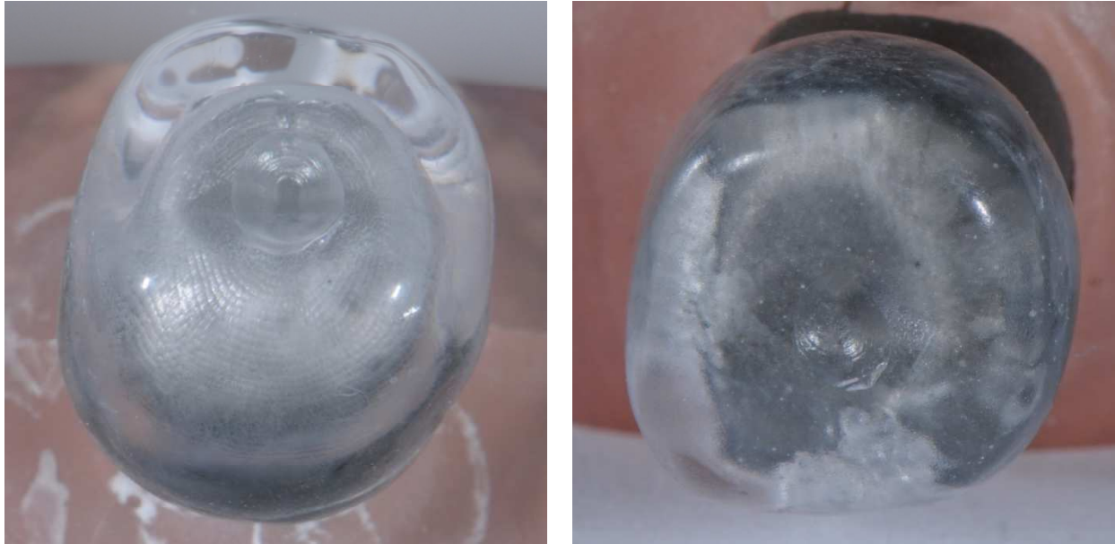
Abbildung 30: Beispiel eines gefrästen (li.) und eines konventionell hergestellten Prüfkörpers (re.) nach Kausimulation
