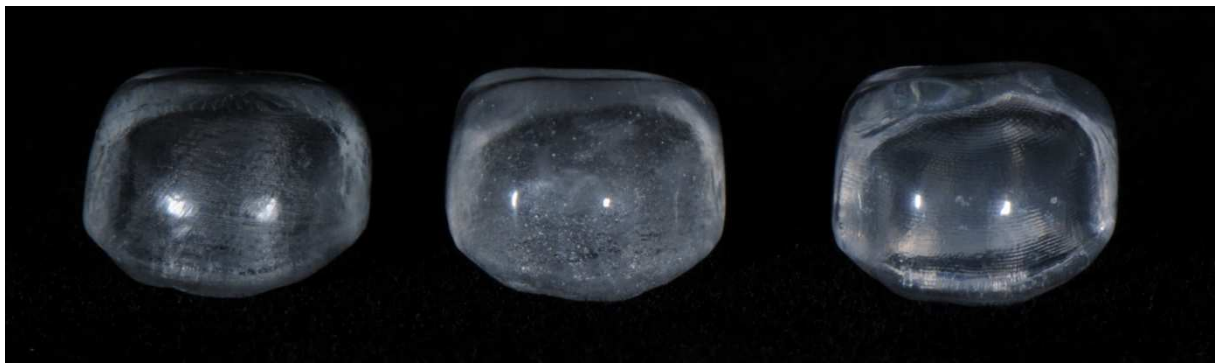
Abbildung 14: Gedruckte, konventionell hergestellte und gefräste Schienenkappchen nach Politur (v. l. n. r.)
