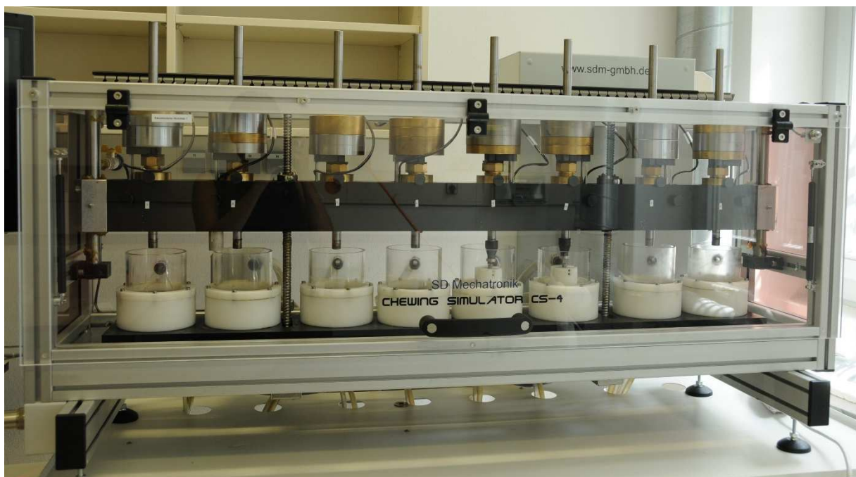
Abbildung 5: Beispiel für einen Kausimulator: CS-4 (SD Mechatronik)
