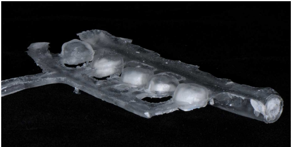
Abbildung 19: Konventionell hergestellte Kronen nach Ausbetten aus der Küvette
