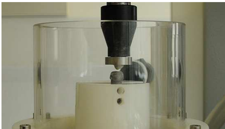
Abbildung 21: Prüfkörper mit Schmelzantagonist in einer Kammer des Kausimulators
