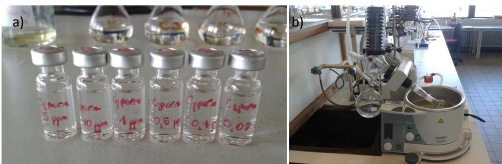
**Figura IV.2:** a) Preparación de disoluciones patrón de cipermetrina para la recta de calibración y cuantificación. b) Matraz de fondo redondo para la concentración del homogenato.
