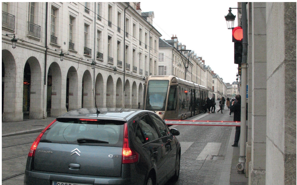
Een driekleurig verkeerslicht, eventueel ondersteund door een lichte slagboom, zorgt er ondubbelzinnig voor dat het aankomende verkeer stopt en dat de rijbaan ter hoogte van de halte volledig vrijgemaakt wordt voor de in- en uitstappende reizigers, zoals hier in Orléans.
