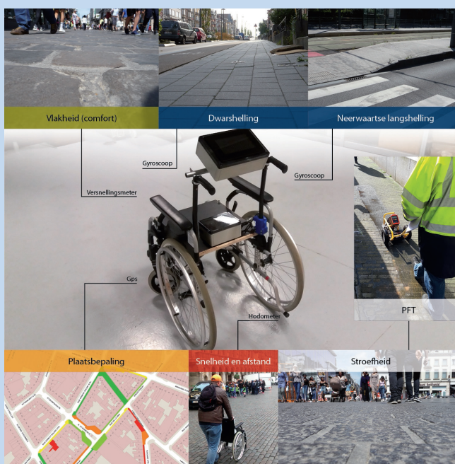
Tool in ontwikkeling (prototype V2) om de gebruikskwaliteit van voetgangersverhardingen te meten.
