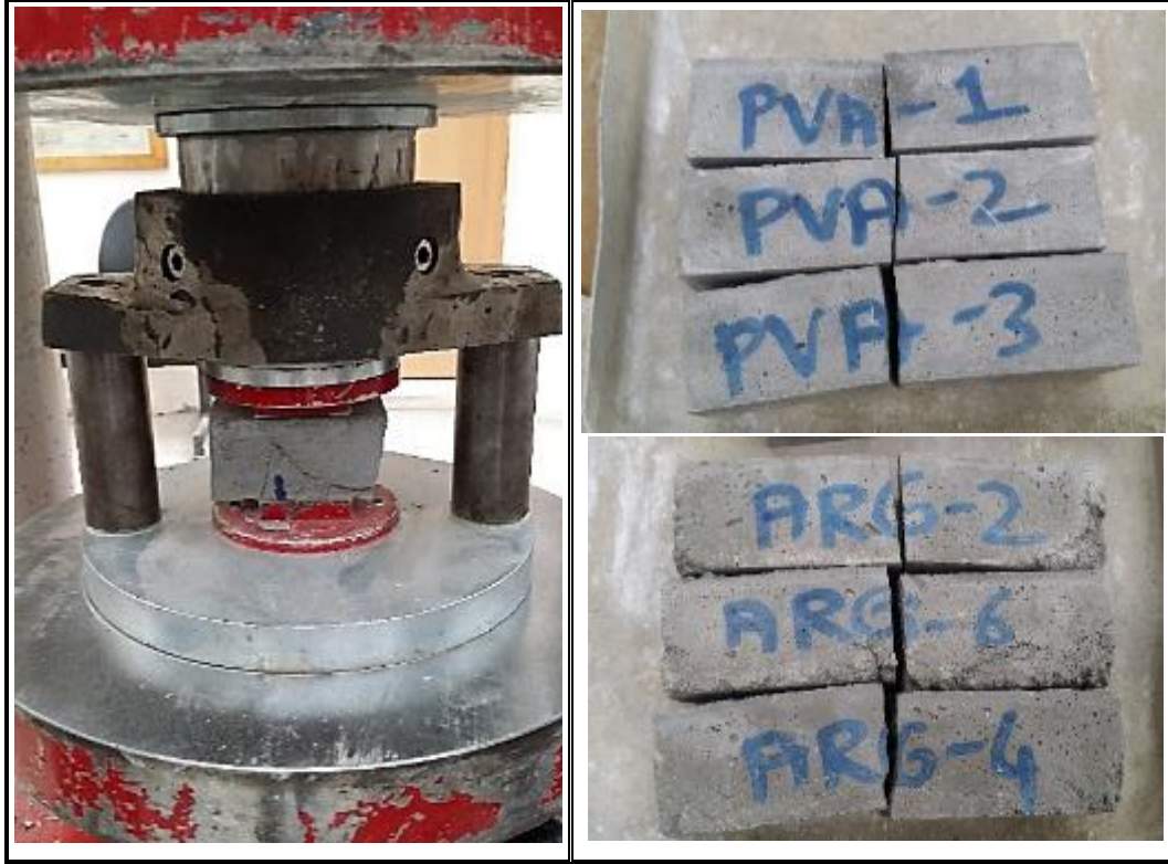
Şekil 2.4: PVA ve AR Glass harcı basınç deneyi.
