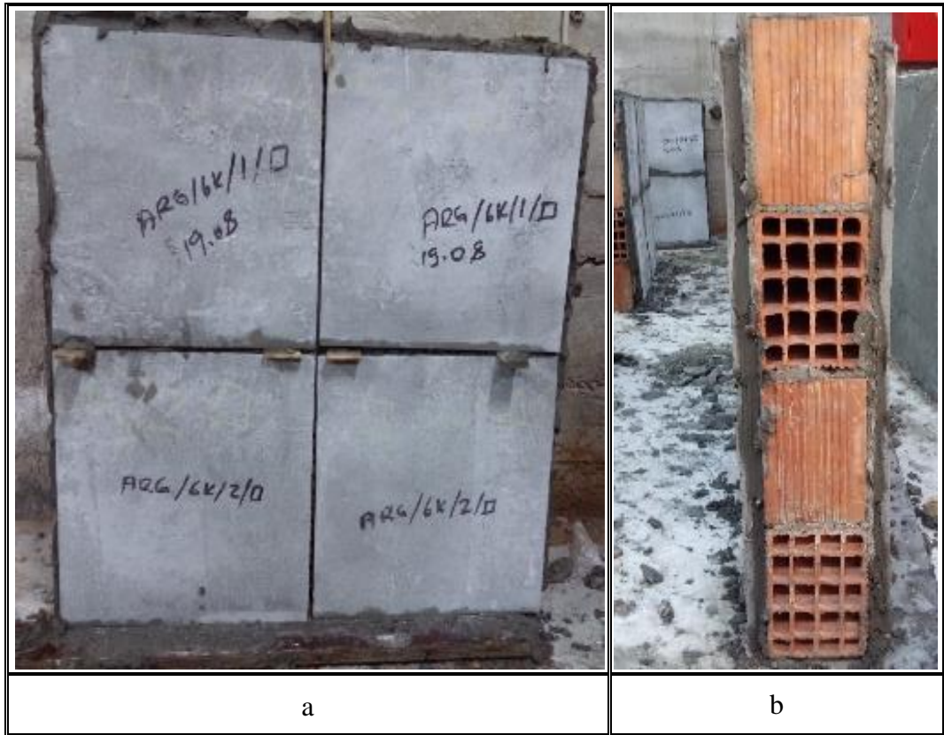
Şekil 3.14: 6 kat AR Glass kompozit plakalarla güçlendirilmiş duvar numunesi a) Önden görünüş b) Yandan görünüş.
