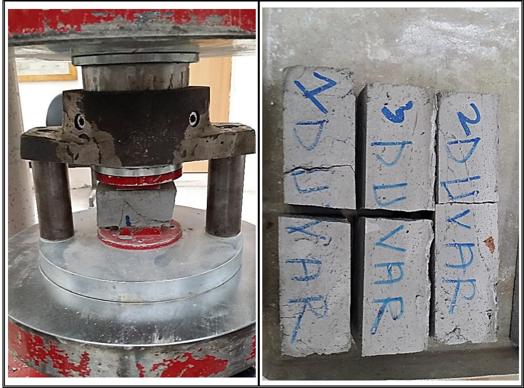
Şekil 3.21: Duvar harcı basınç deneyi.
