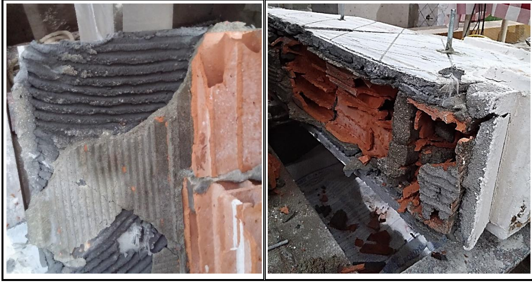
Şekil 3.57: G-4-P-2 numunesindeki kuvvetli aderans ve zorlanan PVA tekstil.
