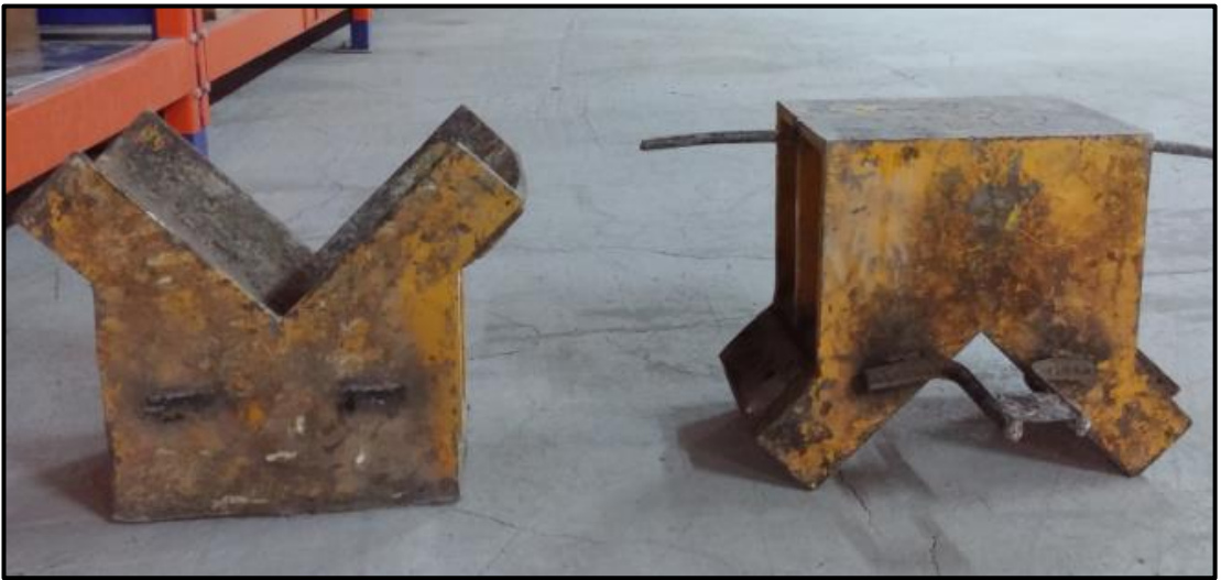
Şekil 3.24: Alt ve üst çelik yükleme başlıkları.
