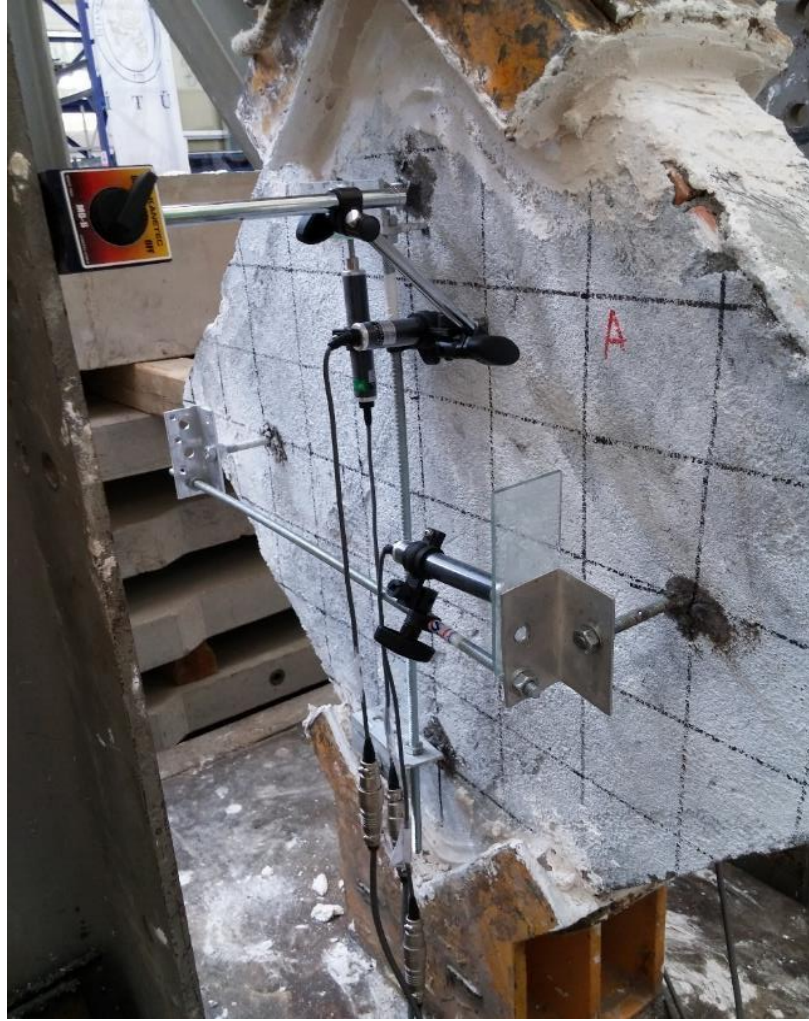
Şekil 3.25: Yerdeğiştirme ölçerler (Transducer, LVDT).
