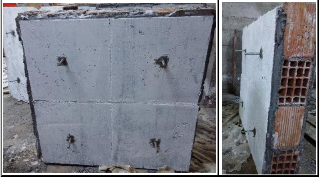
Şekil 3.17: Tijleri yerleştirilen ve yüzeyleri kireç ile boyanan duvar numunesi.
