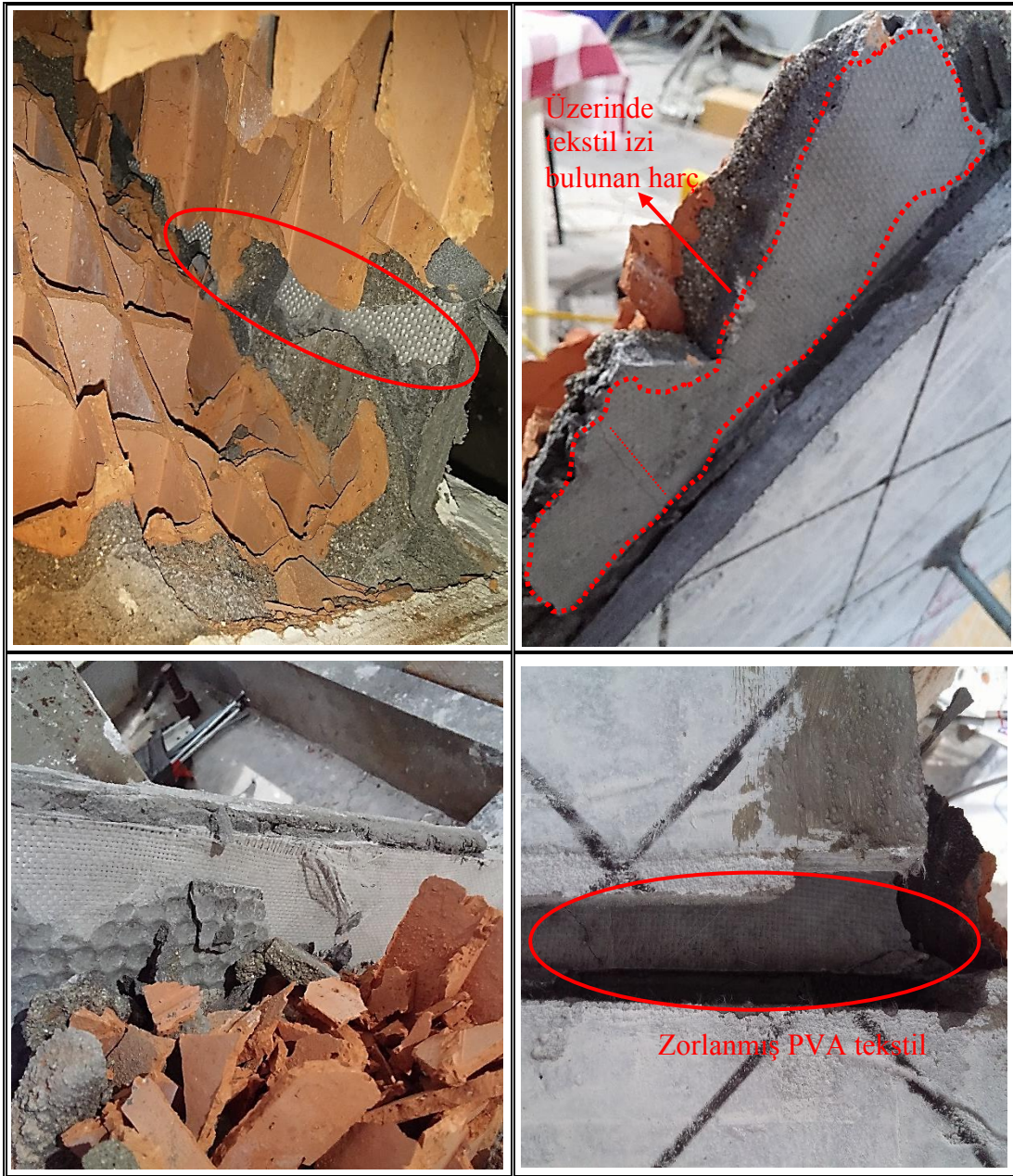
Şekil 3.53: G-4-P-1 numunesinde performansı yüksek olan plakalar ve zorlanmış PVA tekstil tabakası.
