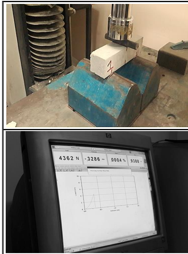
Şekil 3.22: Duvar harcı eğilme deneyi ve verilerin kaydedildiği bilgisayar.
