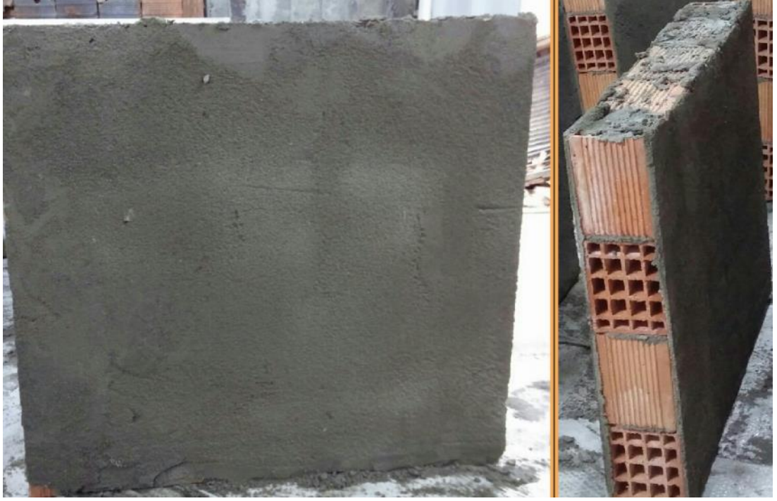
Şekil 3.6: Güçlendirilmemiş duvar numunesi (Üretim sırasında)
