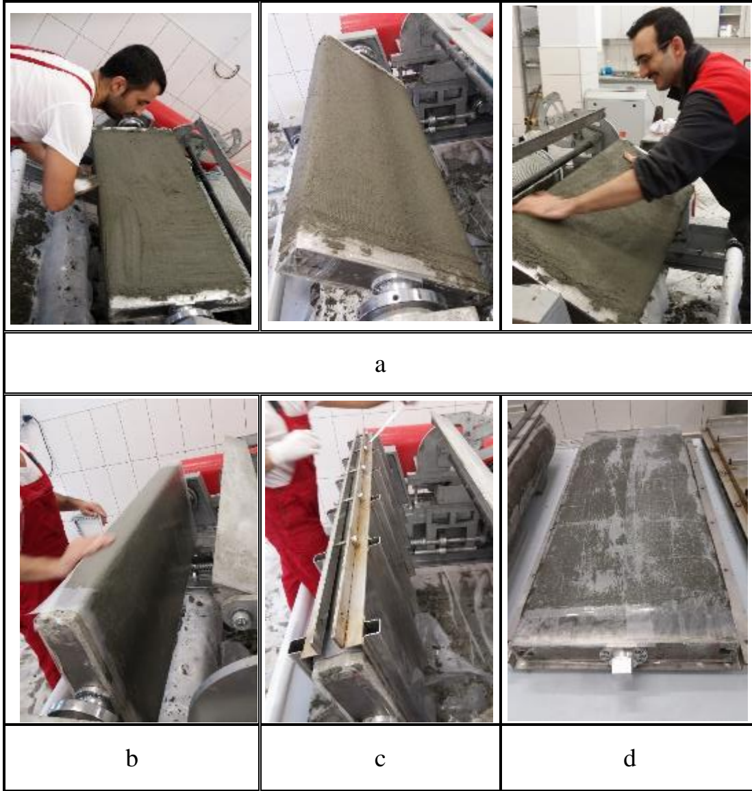
Şekil 2.8: Çimento harçlı tekstilin sarılma ve kalıp aşamaları a) Çimento harçlı tekstilin plaka üzerine sarılması b) Naylon ile tekrar sarılması c) Kalıba alınması d) Kalıptan çıkarılması.
