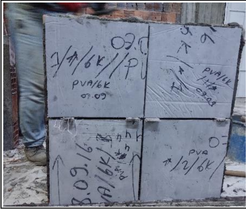
Şekil 3.12: 6 kat PVA plaka ile güçlendirilmiş duvar numunesi.
