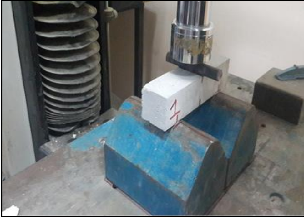
Şekil 2.5: PVA ve AR Glass harcı üç noktalı eğilme deneyleri.
