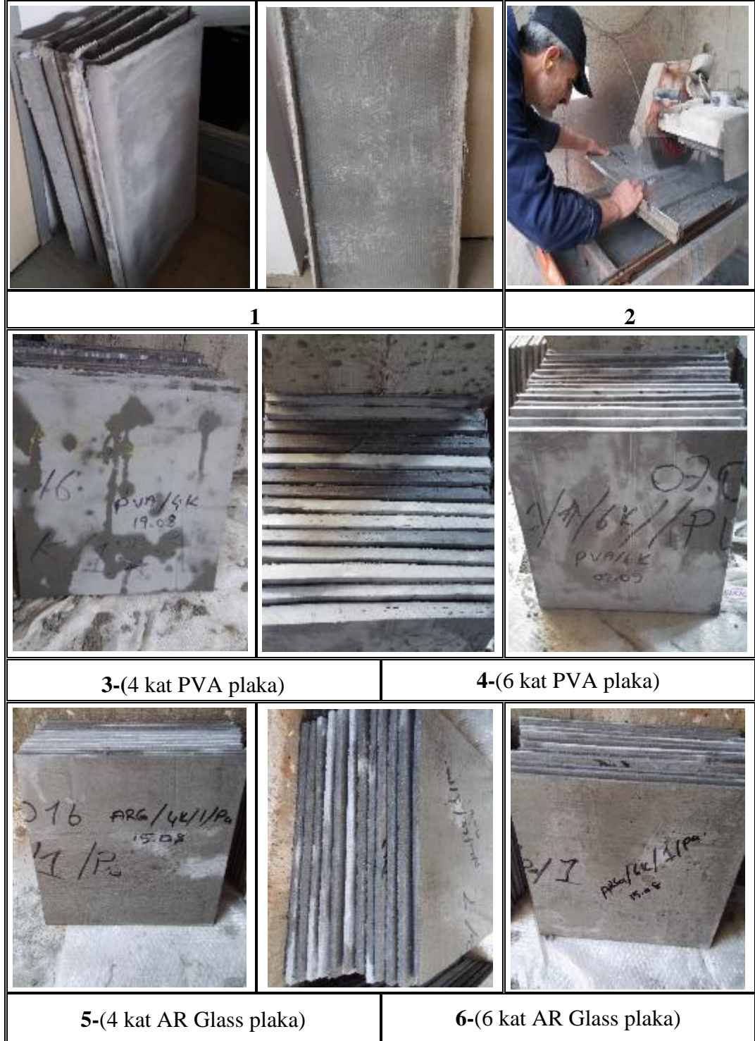
Şekil 2.9: Kompozit plakaların kesim işlemi ve aşamaları.
