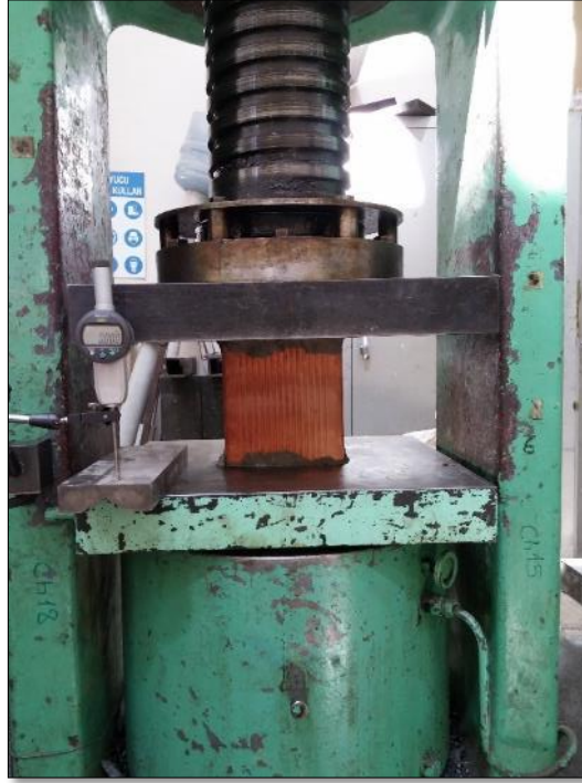
Şekil 3.19: Pres makinesinde basınç deneyi yapılan tuğla örneği.
