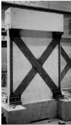
Şekil 1.10: Taghdi deney numunesi ve deney düzeneği.
