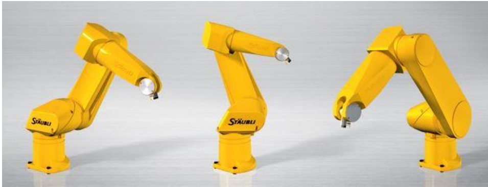
Figure 1.1 : Stäubli RX-160 manipulator [1].
