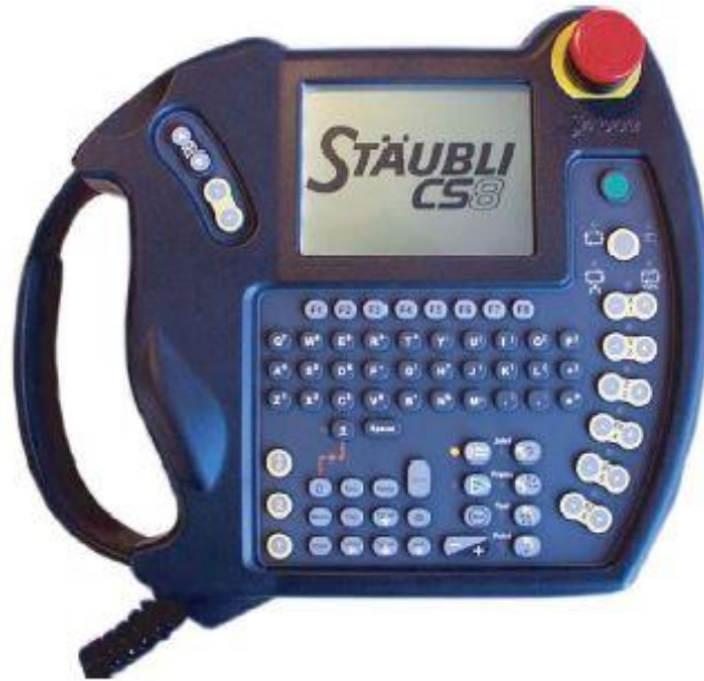
Figure 1.6 : Manual control pendant [8].
