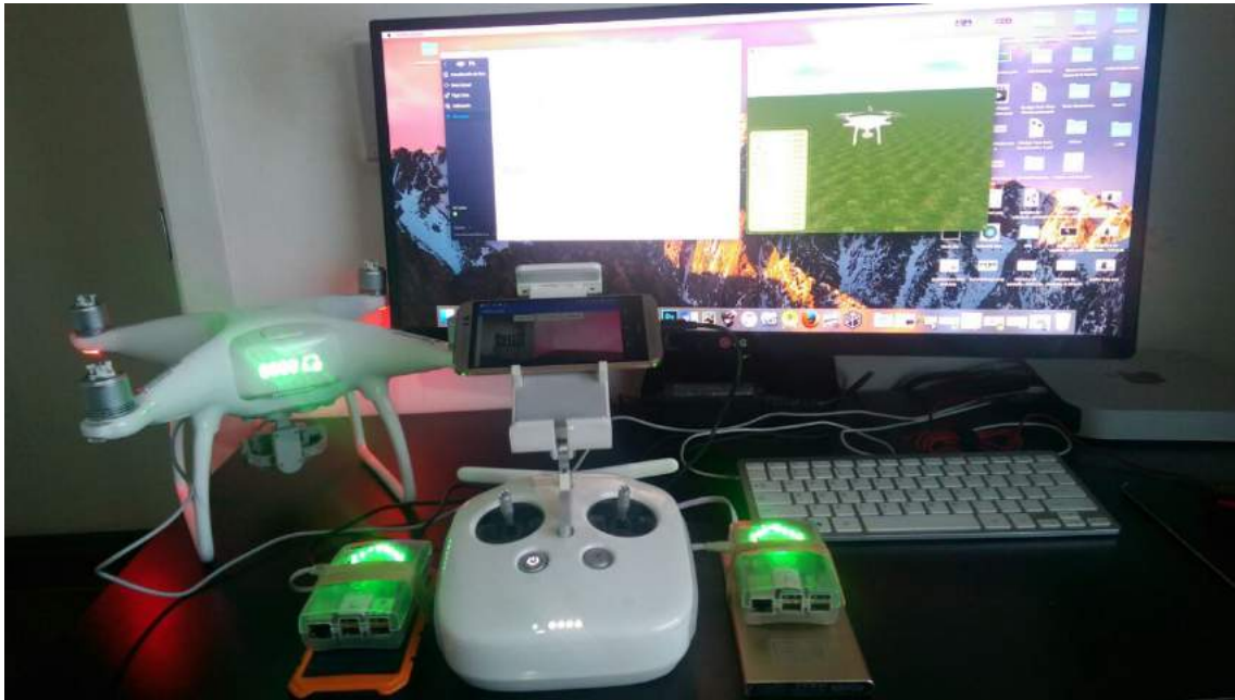
Figura 68 – Control de un drone real (Phantom 4) utilizando los Raspberry Pi en un entorno simulado
