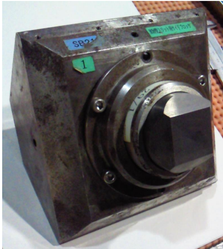
図 2.5.4 超合金（タングステンカーバイト）製一段目アンビル
