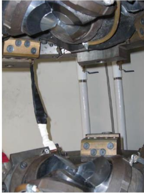
図2.2.8 上下ステージ各3個のタングステンカーバイト製アンビル
