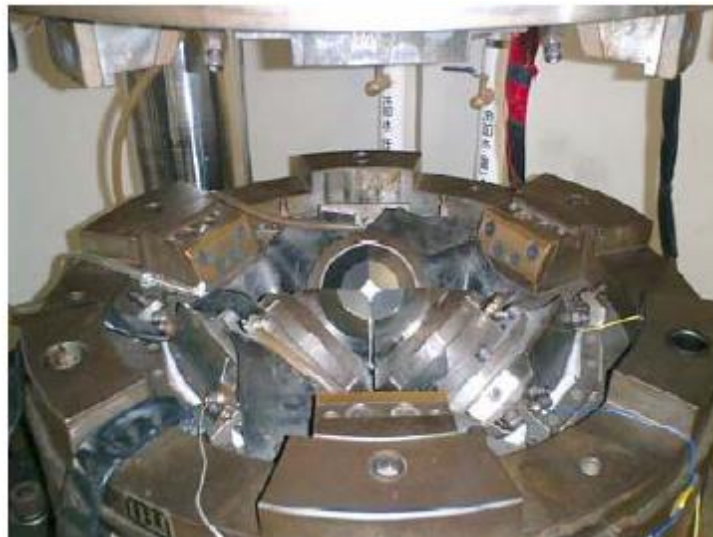
図2.2.9 下ステージ3個のタングステンカーバイト製アンビル
