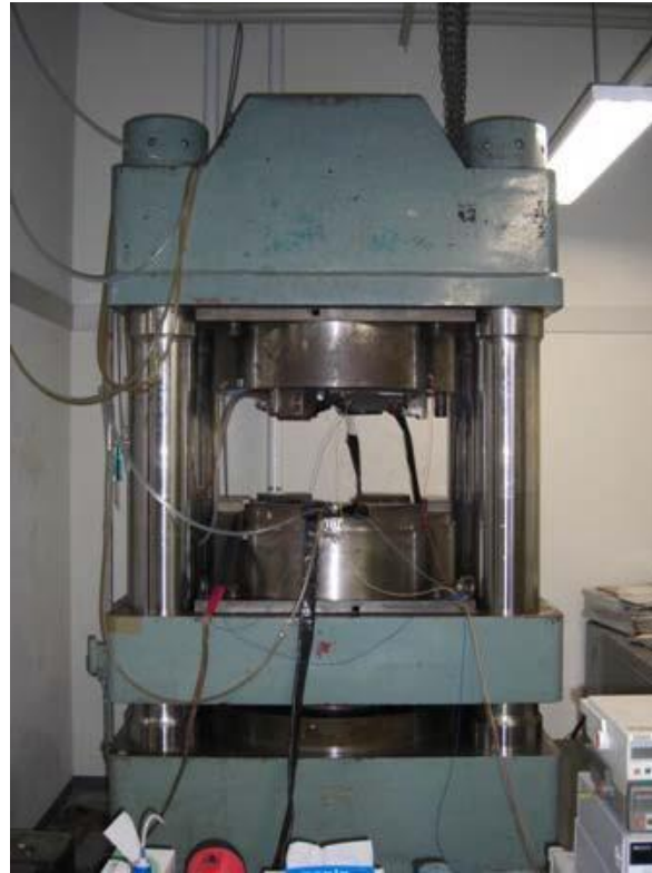
図2.2.6 斜面駆動式キュービックアンビル型高圧発生装置（全体像）
