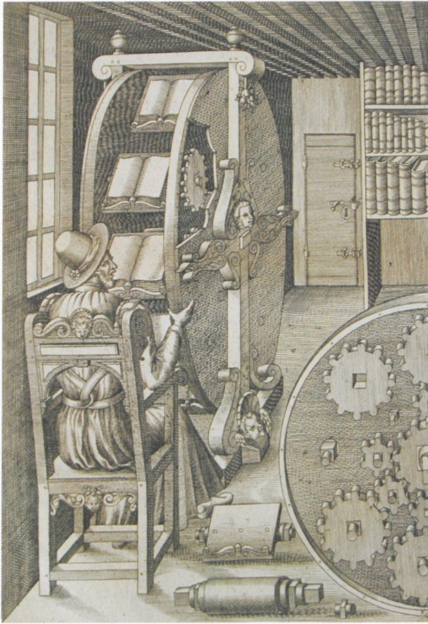
Agostino Ramelli, Konstruktion des Leserades In: „Le Diverse et Artificiose Macchine“, 1588 Universitätsbibliothek Salzburg, Sondersammlungen
