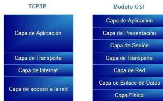
**Figura 1: Comparación del Modelo OSI y TCP/IP**
