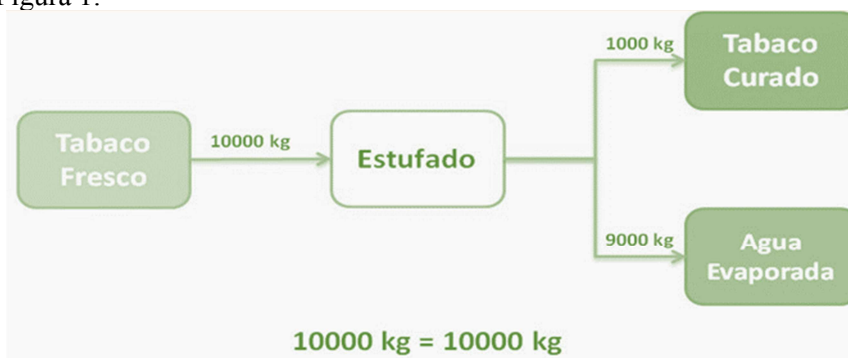
Figura 1: Balance de masa de una estufa de tabaco BC.
