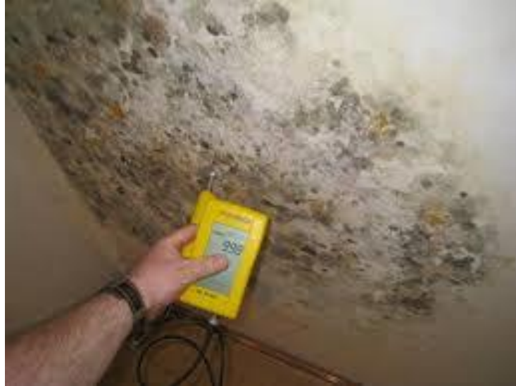
Figura 2.1: Determinación de humedad en un paramento [76]
