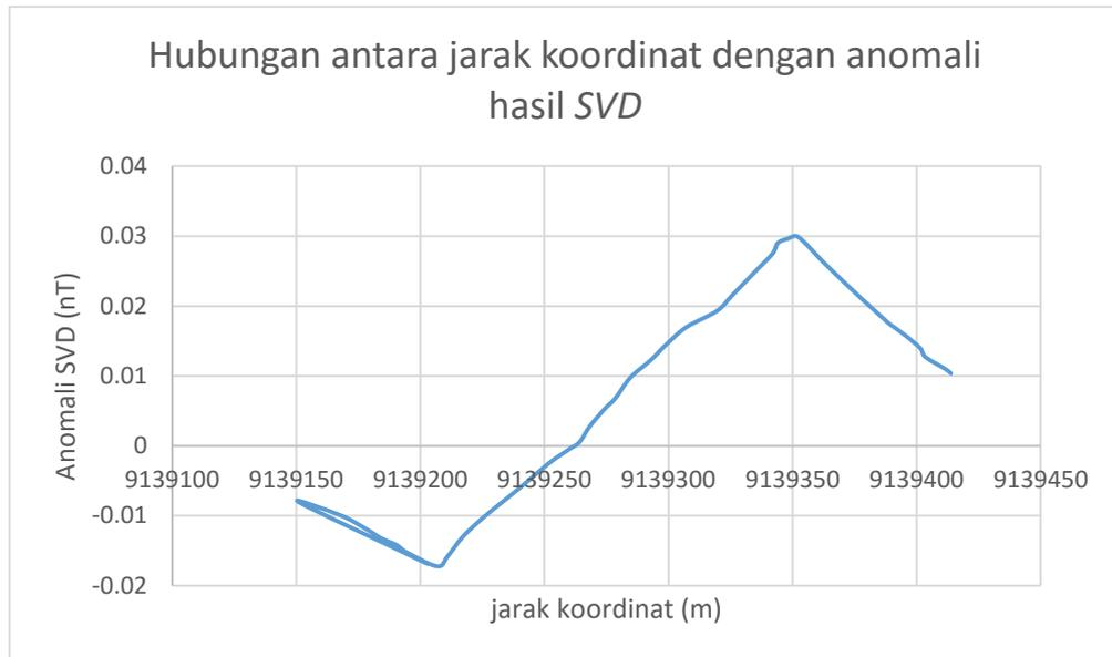
Gambar L27. Hasil *plot* hubungan antara jarak dengan anomali SVD.
