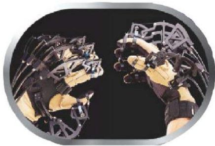
Figura 7 - Luva com atuadores, para sensação de força.
