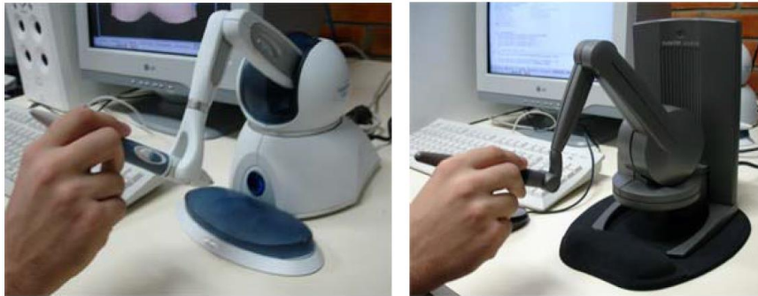
Figura 9 - Dispositivo com 6 DOF e force-feedback .
