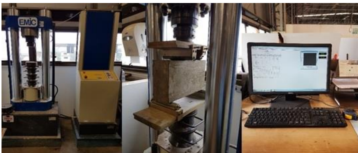
Figura 32 – Ensaio de resistência à tração na flexão
