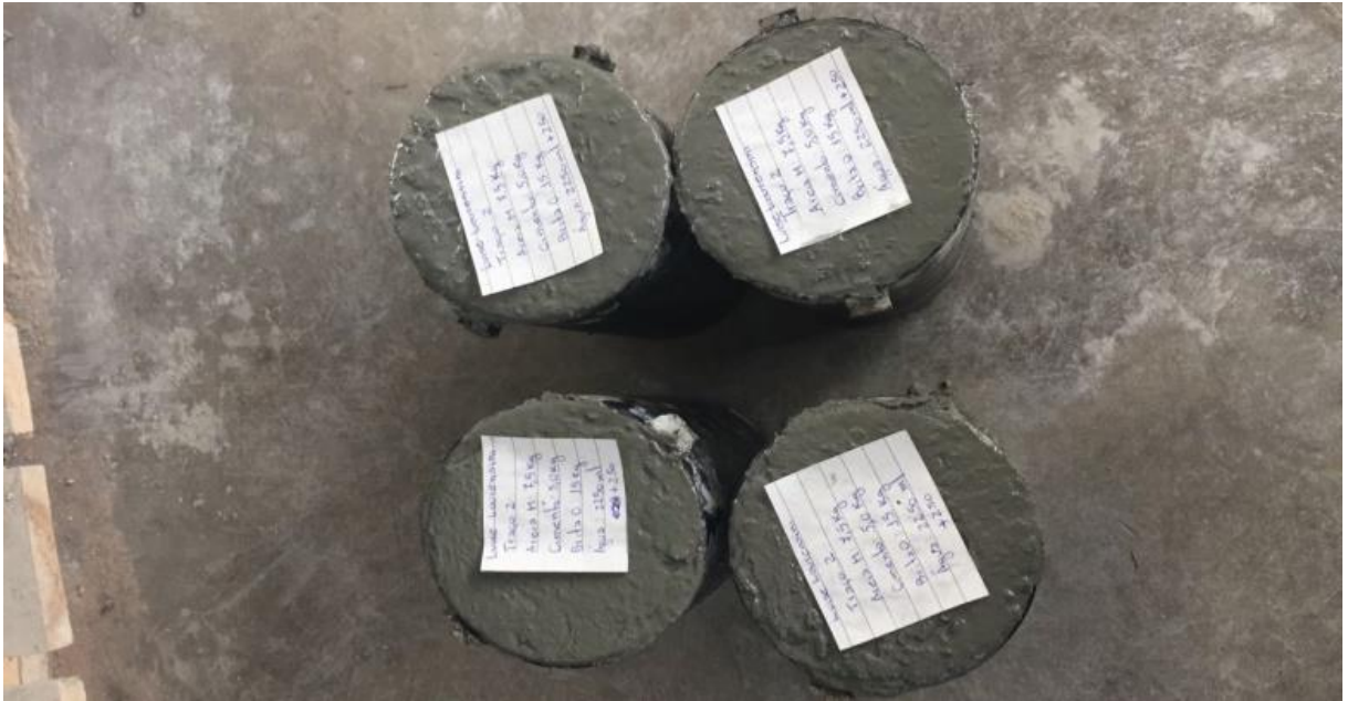
Figura 26 – Corpos de prova de um traço de concreto
