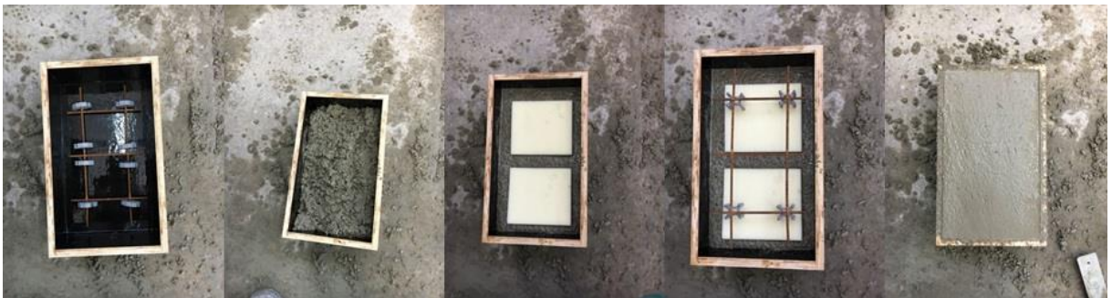
Figura 31 – Moldagem painel poliuretano
