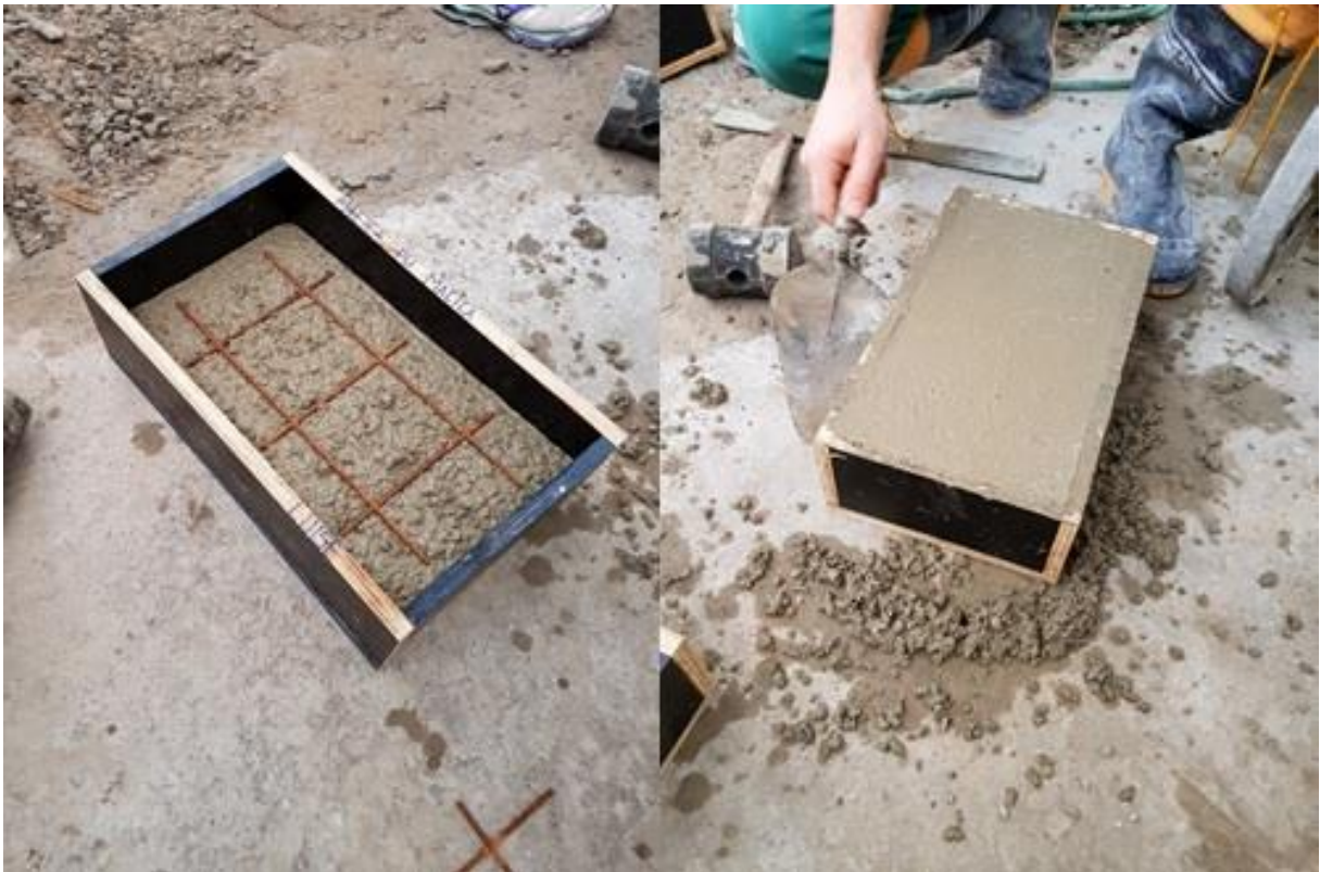
Figura 29 – Moldagem painel maciço
