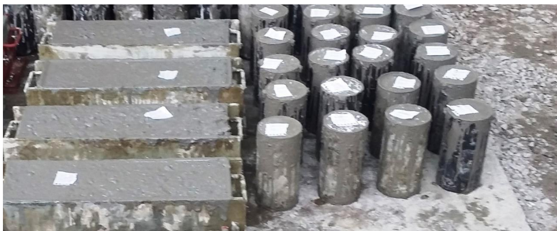
Figura 10 - Moldagem dos Cp's Traço A
