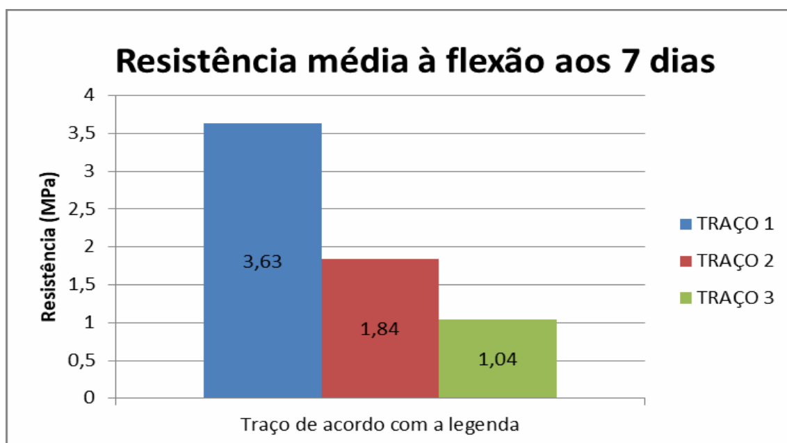
Gráfico 05 – Resistência média à flexão aos 7 dias de cura do concreto
