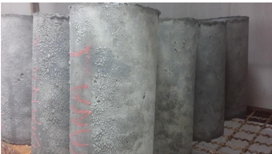
Figura 13 - Cp's na câmara úmida por um período de 28 dias
