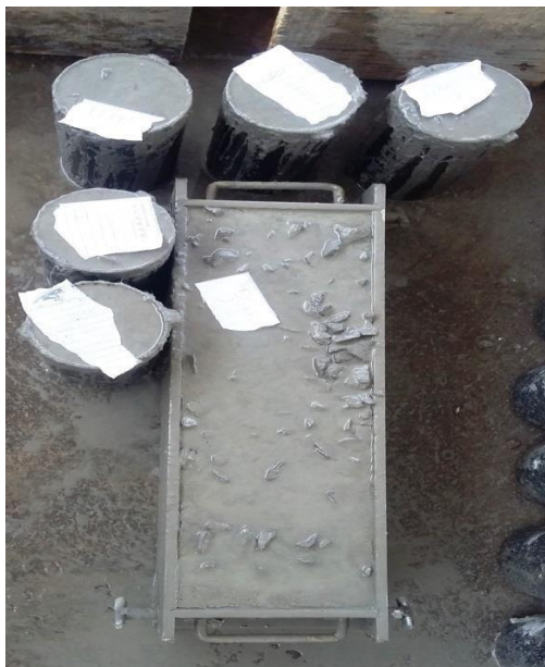
Figura 09 - Moldagem dos Cp's Traço 3
