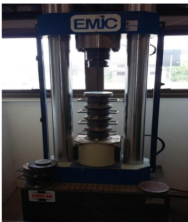
Figura 16 - Prensa empregada para o rompimento dos CP's
