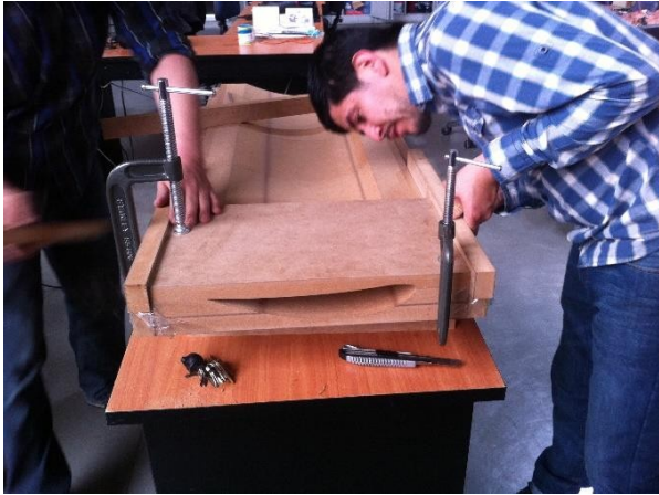
Figura 13. Ensamble segmentos componente A molde (Fuente: Autor).
