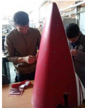
Figura 2: Alistamiento de carrocería para escaneo 3D. (Fuente: Autor).
