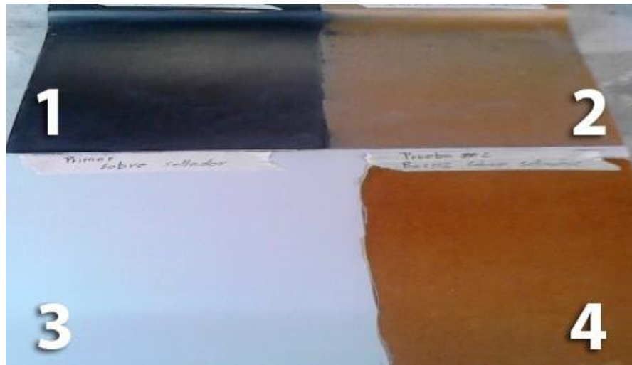
Figura 15. 1. Pintura de Poliuretano sobre Madera, 2. Barniz sobre Sellador para Madera, 3. Primer sobre Sellador para Madera y 4. Barniz sobre Madera (Fuente: Autor).
