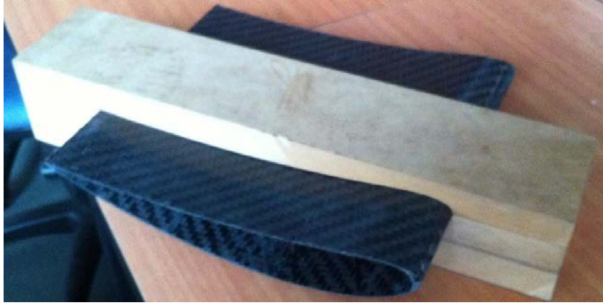
Figura 22. Resultado prueba infusión de ala frontal. (Fuente: Autor).
