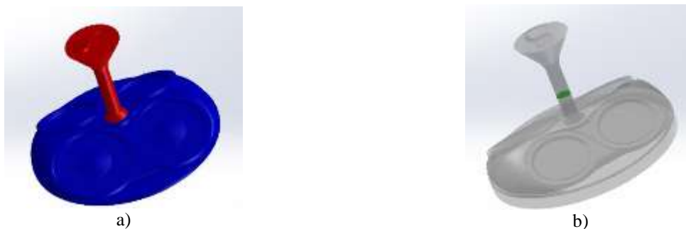
Figura 3. a) Separação do volume da pré-câmara (região vermelha) da região da câmara principal (região azul); b) Localização do plano de extração da velocidade.
