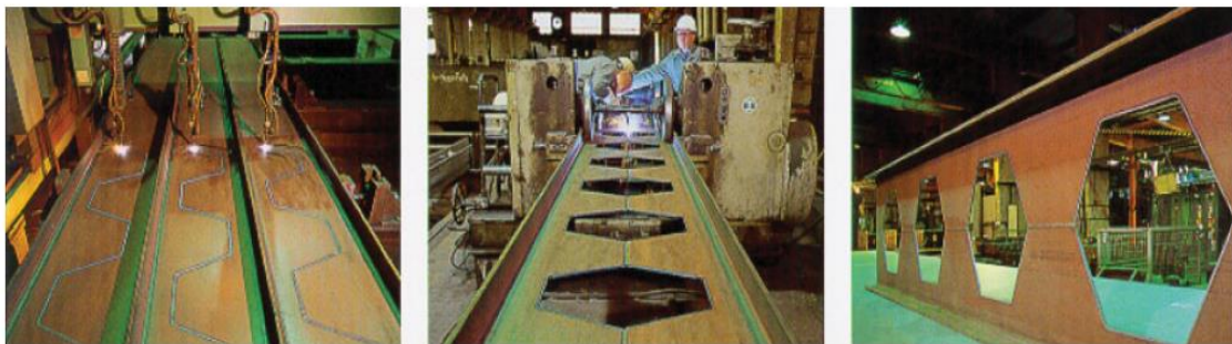
Figura 1. Fabricação de uma viga castelada (Gemperle, 2007).
