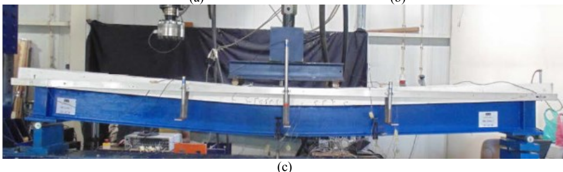
Figura 2. Ensaio com Crestbond: (a) ensaios tipo push-out experimentais (Veríssimo, 2007); (b) modelo numérico de ensaio push-out , com dupla simetria (Silva, 2013); e (c) ensaios de vigas mistas (Alves, 2014).
