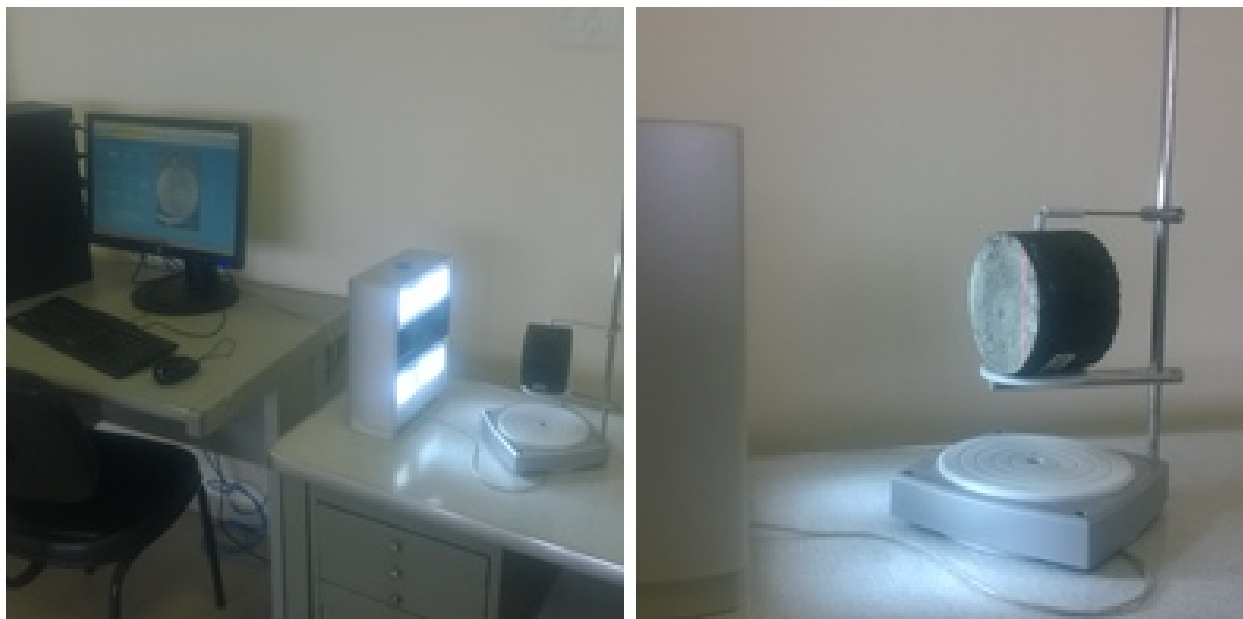
Figura 2. Procedimento de obtenção da nuvem de pontos de um dos corpos de prova em laboratório.
