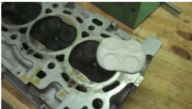
Figura 1. Cabeçote do motor Ford Sigma com o molde de silicone da câmara de combustão
