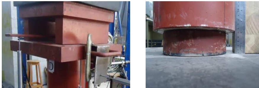
Figura 5. Condições de contorno: (a) atuador; (b) base;
