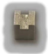
Figura 1. Cavidade preparadas no bloco de alumínio Figura 2 Imagem da montagem para aquisição de imagens, com a câmera, fotopolimerizador e bloco de alumínio.
