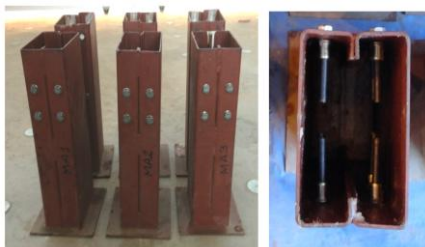
Figura 1 - Modelos antes de serem concretados: vista externa dos modelos e vista interna dos modelos. (CARDOSO et alii, 2014).
