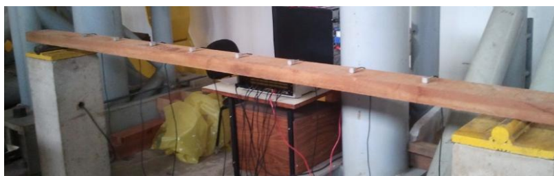
Figura 7 – Viga de madeira instrumentada com 8 acelerômetros.
