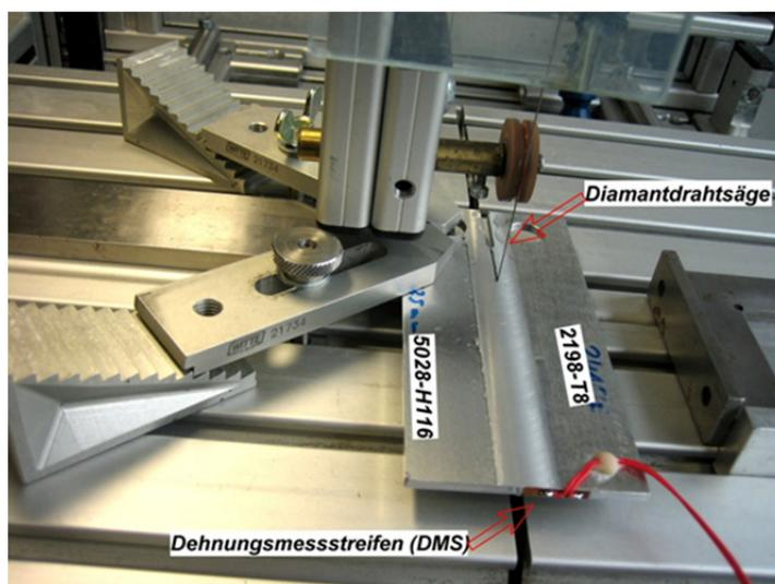
Abbildung 2-35: Versuchsaufbau der Cut-Compliance Eigenspannungsmessung
