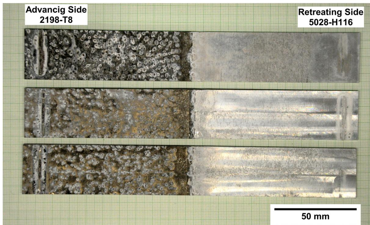
Abbildung 2-28: Mittels Vier-Punkt Biegung belastete FSW AA2198/AA5028 Proben nach 1000 h Wecheltauchtests
