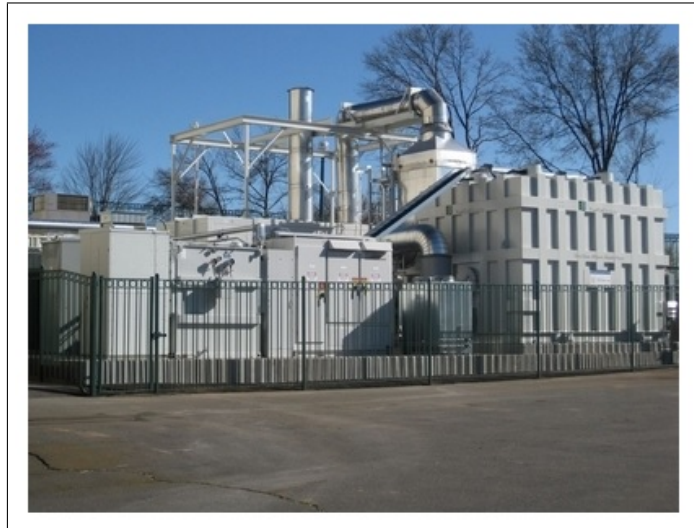
FIG. 1.1 – Système DFC1500 développé par la société FuelCell Energy, Inc. Il se compose de MCFC développant une puissance électrique de 1.4 MW (avec un rendement électrique de 47%). Le système peut être alimenté de manière directe par du gaz naturel. Une unité similaire est installée depuis 2013 à l'hôpital Hartford situé dans le Connecticut (USA) [5].
