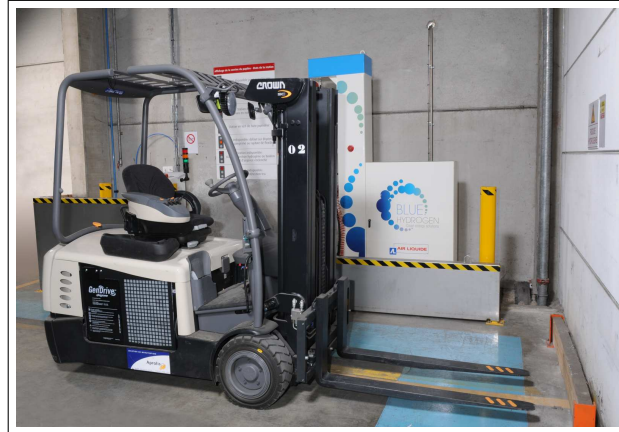
FIG. 1.9 – Chariot élévateur HyPulsion. Avec une puissance de 10 kW et de l'hydrogène stocké à 350 bar, le chariot a une autonomie de 8 heures et le plein d'hydrogène s'effectue en 3 minutes [22].
