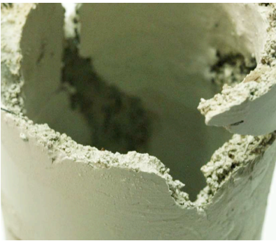
fig 2 – pormenor de ensaio com formigas
