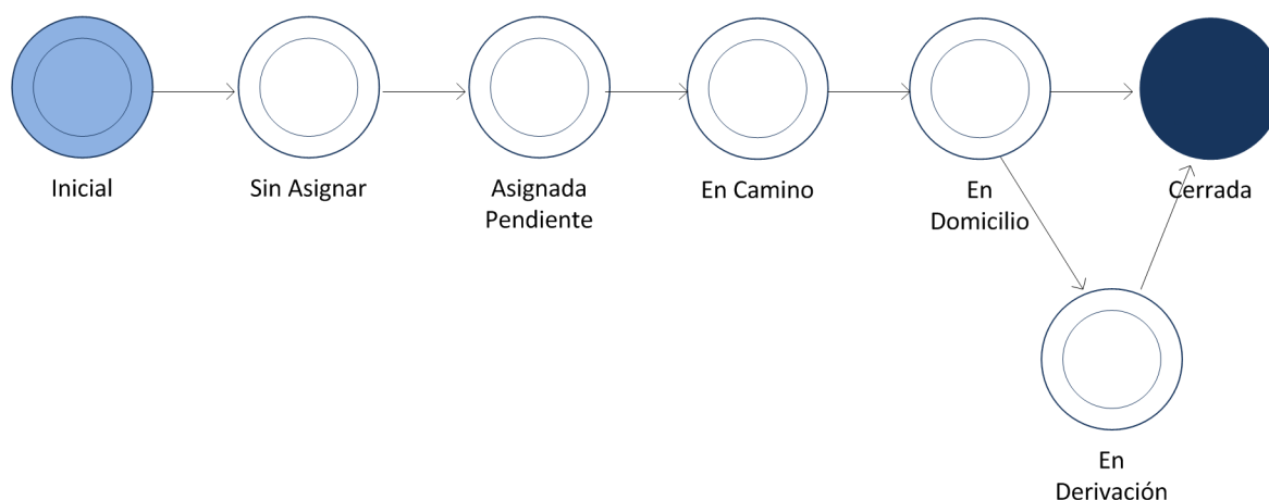
Figura 9.5: Diagrama de Transición de estados de una prestación
