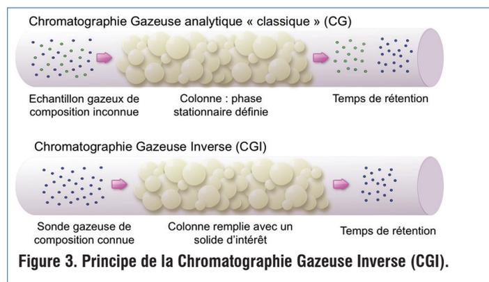
**Figure 3. Principe de la Chromatographie Gazeuse Inverse (CGI).**
