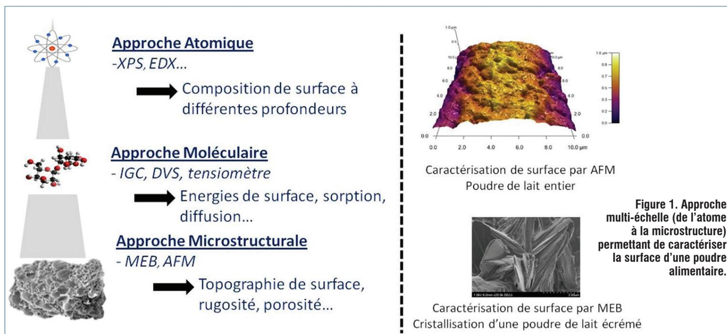
Figure 1. Approche multi-échelle (de l'atome à la microstructure) permettant de caractériser la surface d'une poudre alimentaire.
