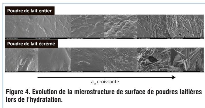
microscopie électronique à balayage permet d'identifier les modifications microstructurales de surface (Figure 4).
