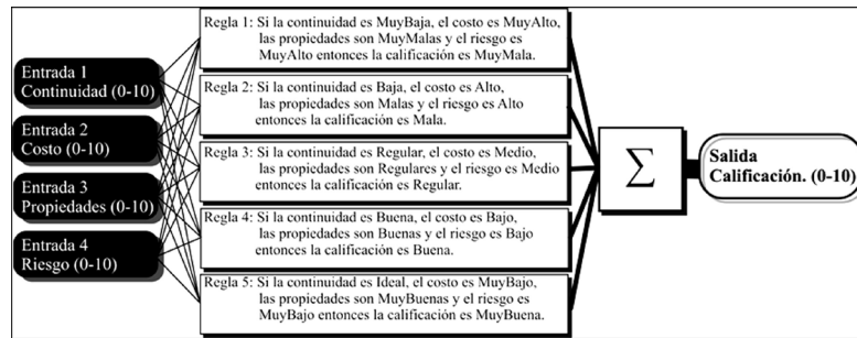
Figura 3. Metodología con lógica borrosa: variables de entrada, planteo de reglas, fuzzificación y defuzzificación, resultados.
