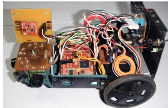
Fig.2 Prototipo Modificado un arreglo de cinco sonares y sensores de percepción interna.
