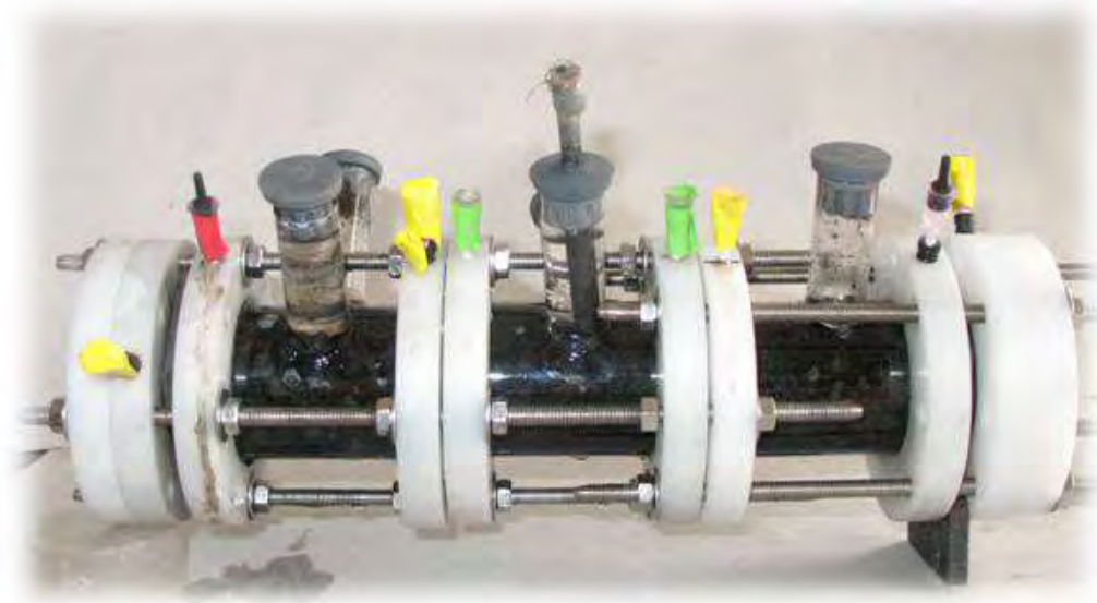
Figura 6.1. a) Representación esquemática del sistema experimental y b) fotografía del reactor de tres compartimentos.
