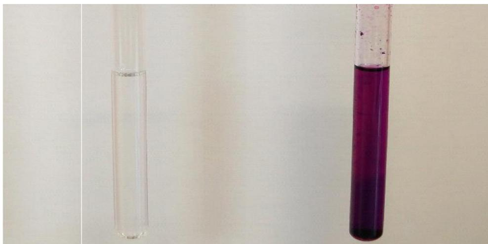
**Abbildung 5.1:** Farbwechsel bei der Oxidation des Thianthrens (**1**) nach Zugabe von Aluminiumtrichlorid. Thianthren (**1**) (links), Thianthrenradikalkationtetrachloroaluminat (**1**<sup>+</sup>) (rechts).
