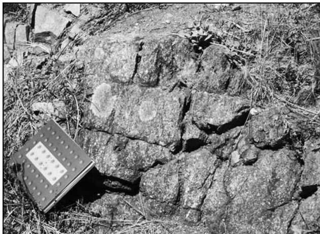
Figura 1. Detalle del material rocoso aflorante en la margen derecha (ZLE1). Se observa alteración y con precisión las características del complejo diaclasamiento superficial del milonitizado Basamento Cristalino, característico en toda el área de estudio.
