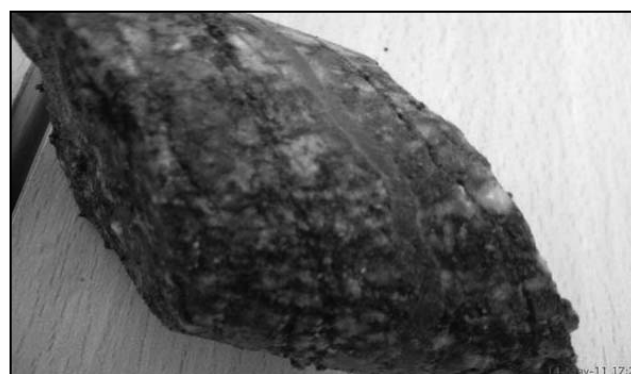
Figura 15. Control de la inyección. Lechada fraguada relleno fisuras en fragmento de testigo de perforación (gneis alterado y cizallado).
