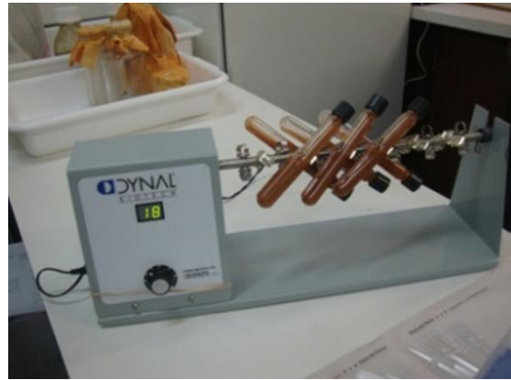
Figura 3. Amostras de solo sendo homogeneizadas no mixer rotatório. Este foi o tratamento escolhido.
