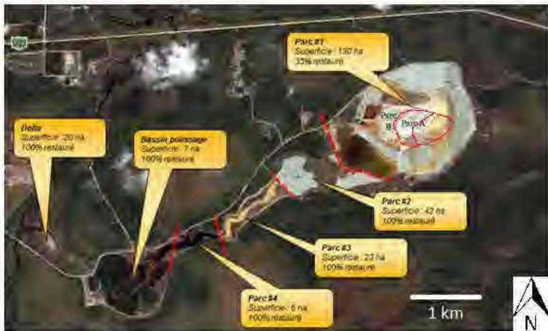
Figure 2.5 Localisation des rejets miniers sur le site Manitou, incluant les zones de dépôt originales parcs A et B, ainsi que les nouvelles subdivisions pour la restauration : parcs 1, 2, 3 et 4 (gracieuseté d’Agnico-Eagle; photo de 2013 et données de 2017; les tirets rouges représentent les frontières entre les différentes zones du site)
