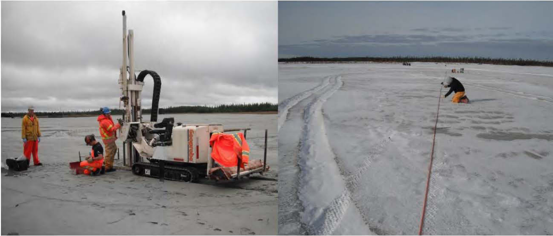
Figure 2.7 Forage environnemental et installation des électrodes du sondage électrique pour les mesures de résistivité
