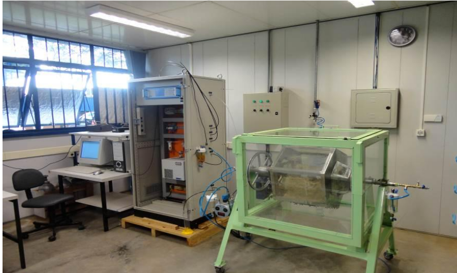
Figura 2. Estrutura do processo de experimentos de compostagem formada basicamente por: tambor rotativo, analisador de gases e aquisição de dados. Figure 2. Device used in the composting experimental process. Basically, it includes a rotative cylinder, a gas analyzer and a data logger system.
