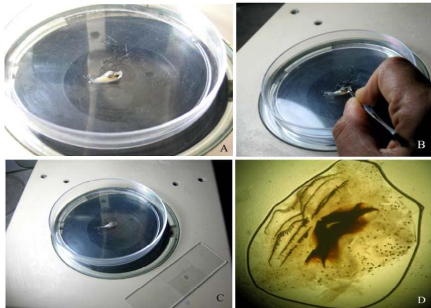
Figura 2.5. Visualización directa del disco oral de las larvas. Disección del disco oral (A y B); disposición en portaobjetos y recubrimiento con cubreobjetos (C); Observación al microscopio óptico (D).
