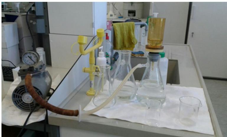
**Figura 5.** Sistema de filtración a vacío.
