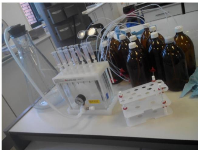
**Figura 7.** Extracción a vacío en columna C<sub>18</sub> de 500mg-6mL ISOLUTE SPE
