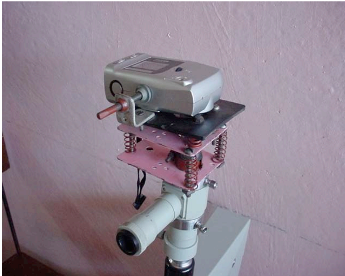
Figura 2: Adaptador de cámara digital para microscopio y estereoscopio.
