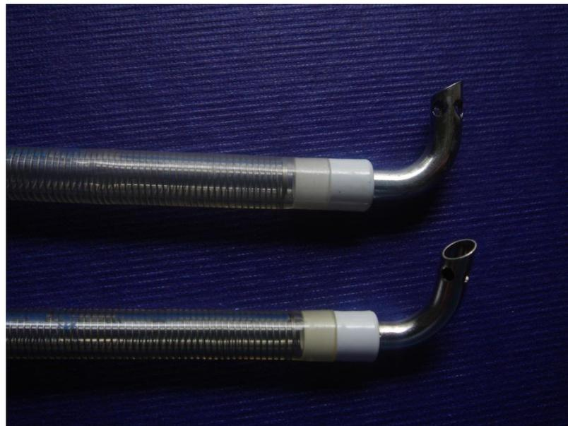
**Figura 15. Cánulas DLP Pacífico® utilizadas para canular la aurícula izquierda en el grupo II**
