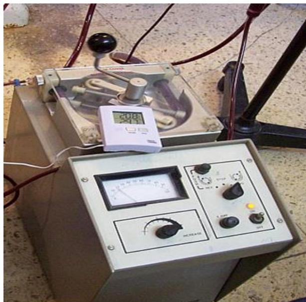
Figura 11. Roller arterial para CEC. Sarns®
