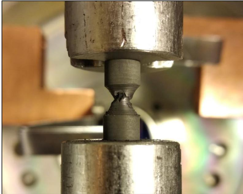
*Figura 5.25 Rottura caratteristica dei provini a clessidra, in corrispondenza della sezione ristretta.*
