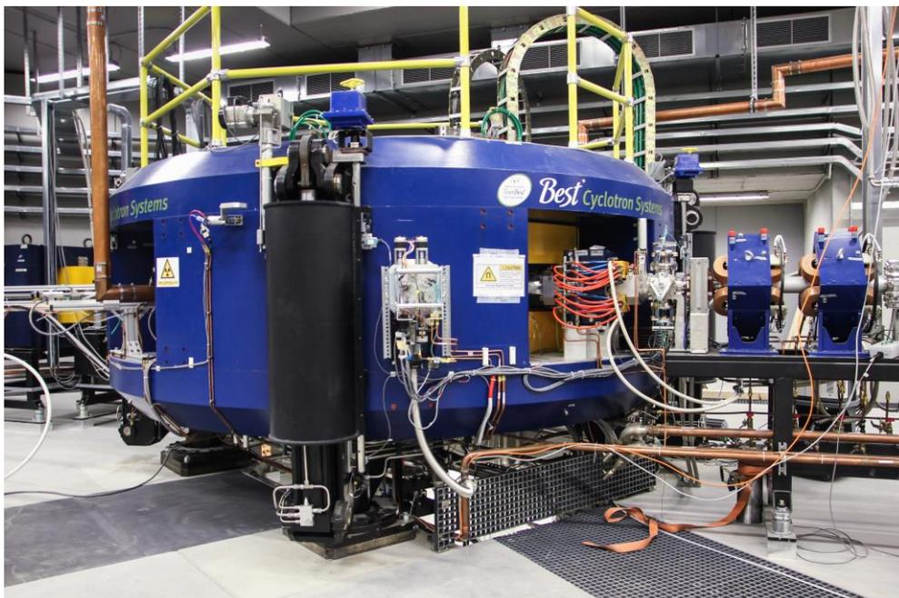
Figura 1.7 Il ciclotrone BEST 70p presente all'interno della facility SPES [5].
