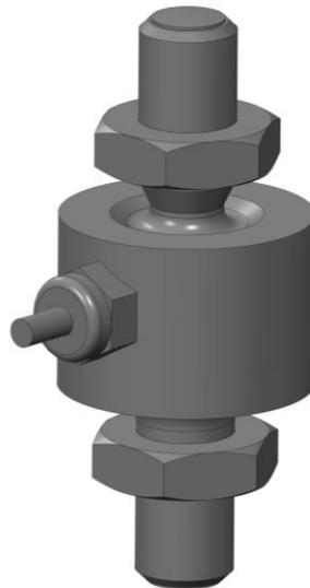
Figura 4.18 Modello CAD della cella di carico HBM U9C-10kN, scelta per le prove sperimentali.
