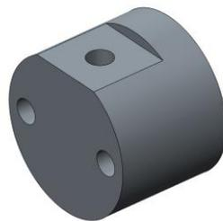
*Figura 4.8 Particolare delle spianature delle estremità in tantalio.*
