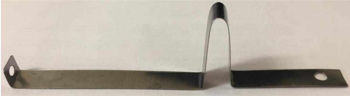
*Figura 4.7 Una delle lamine in tantalio utilizzate per riscaldare il provino.*
