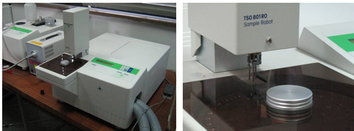
Figura I-1: Fotografies del calorímetre Mettler DSC822e (esquerra) i detall del braç robòtic TSO801RO (dreta).
