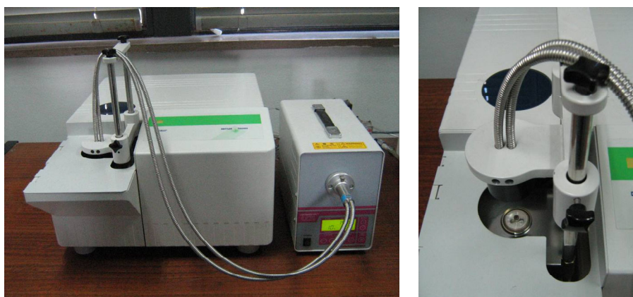
Figura I-4: Fotocalorímetre Mettler DSC821e amb la làmpada UV Hamamatsu Lightningcure LC5 (esquerra) i detall de la modificació del calorímetre per a permetre la irradiació.
