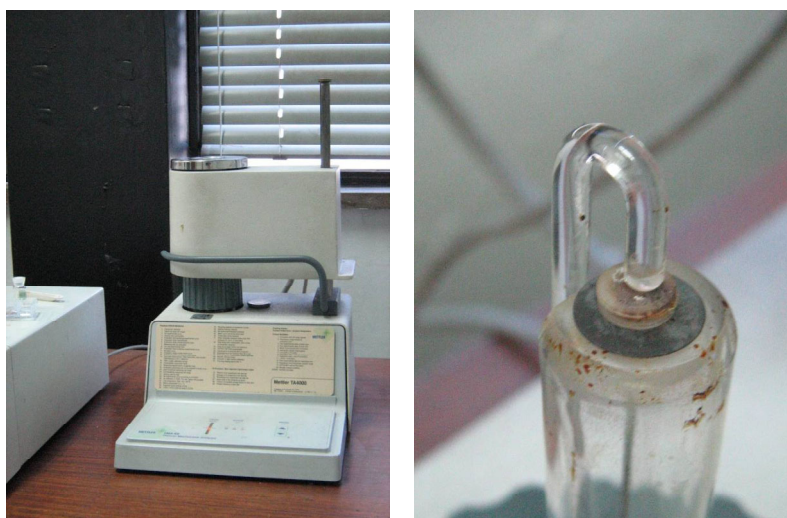
Figura I-13: Analitzador tèrmic-mecànic Mettler TMA 40 (esquerra) i detall de la sonda amb una mostra suportada en fibra de vidre i discos de quars (dreta).
