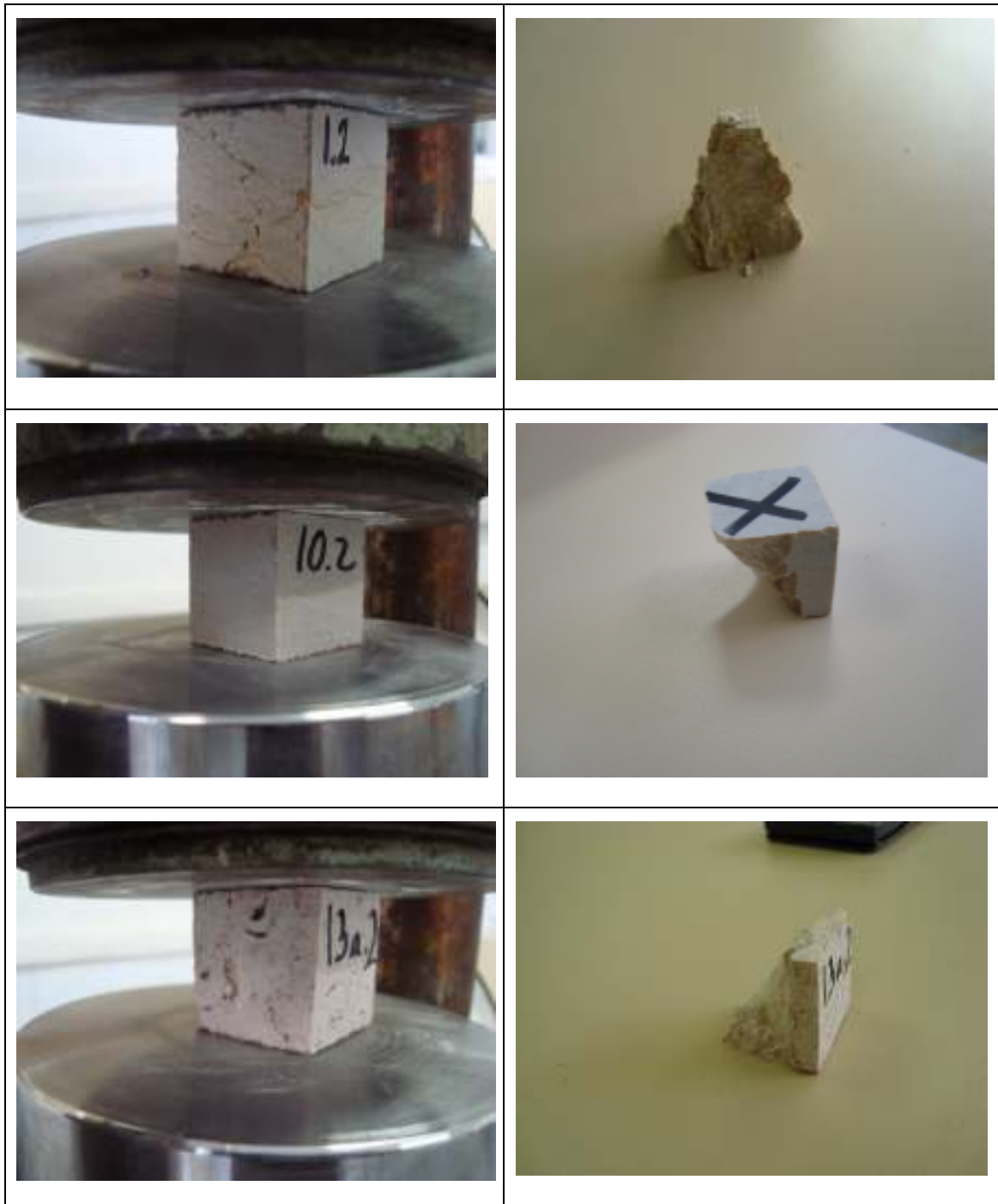
Figura 10. Exemple dels tipus de trencaments de les mostres analitzades.
