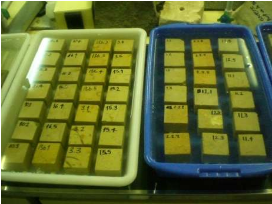
Figura 5. Imatge que mostra la realització de l'assaig d'absorció d'aigua a pressió atmosfèrica.
