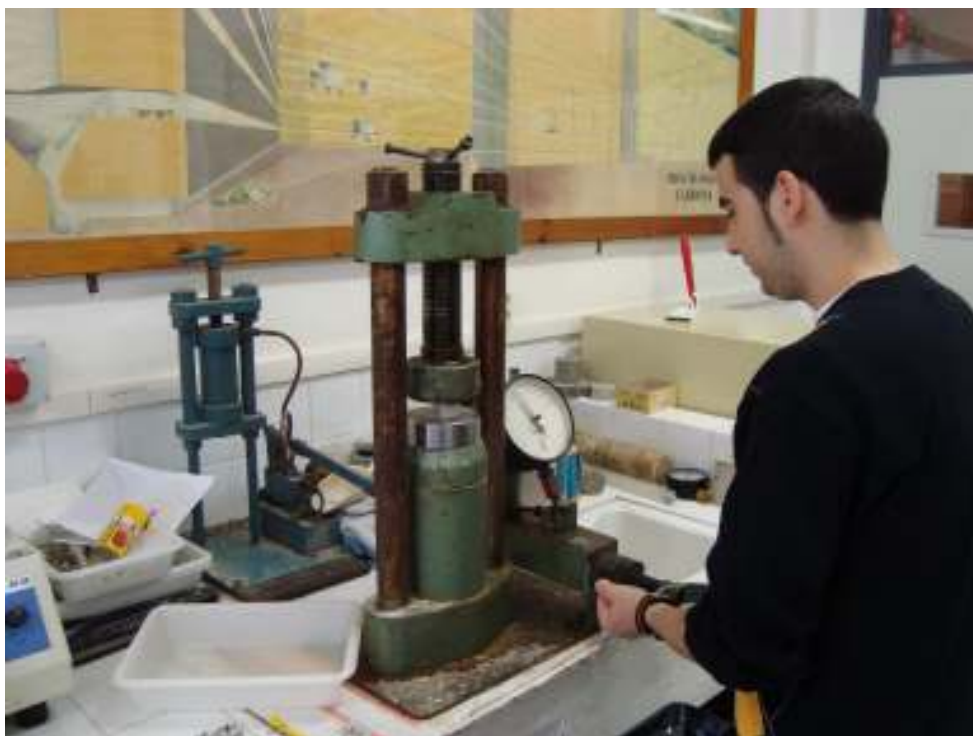
Figura 7. Imatge feta durant la realització de l'assaig de resistència a la compressió simple.
