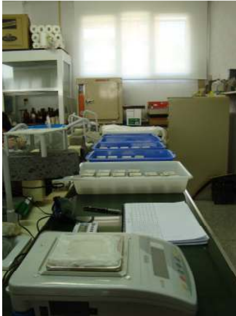
Figura 6. Material utilitzat per a la realització de l'assaig d'absorció d'aigua per capil·laritat.
