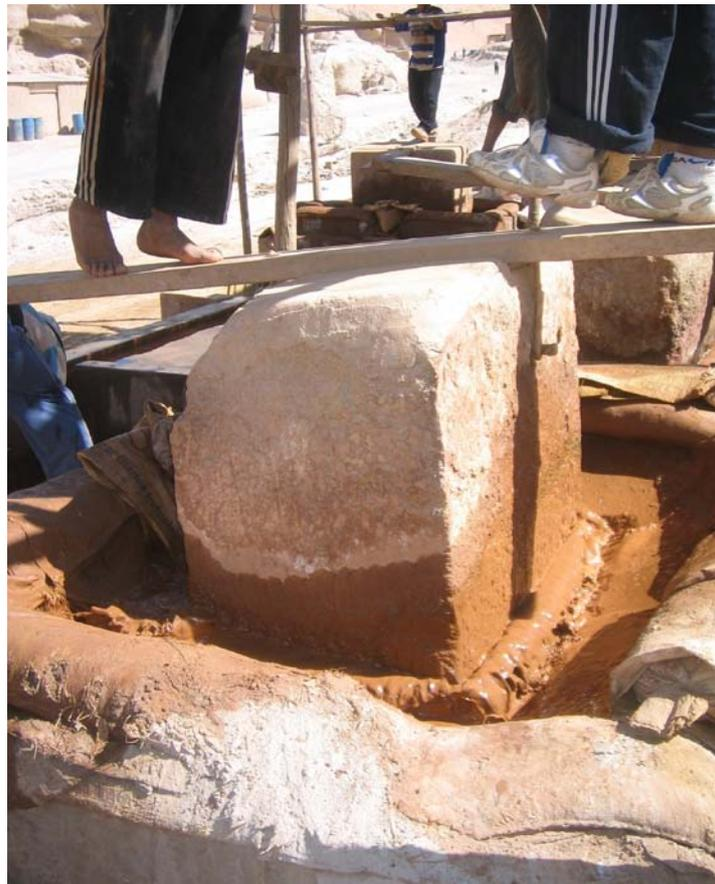
Figura 4. Detalle de la molturación en el quimabaete mediante un gran bloque pétreo.
