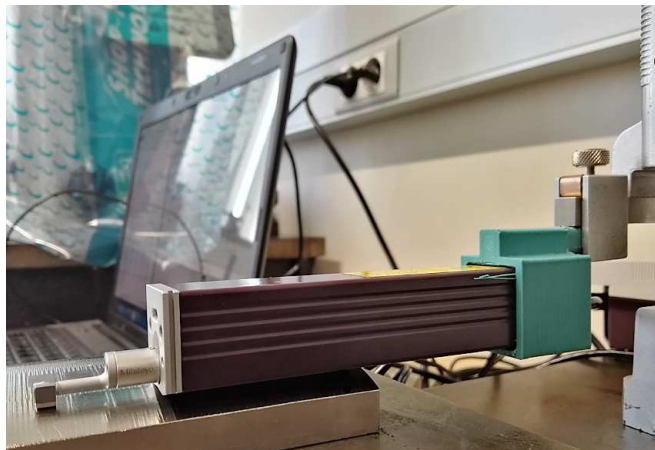
Figura 3. 7 Rugosímetre Mitutoyo fixat al rosset
