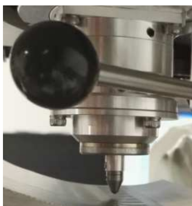
Figura 3. 14 indentador piramidal vickers amb un angle base 136°
