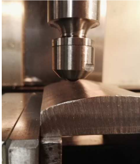
Figura 3.3 Posicionament de la peça i l'eina per fer el brunyit
