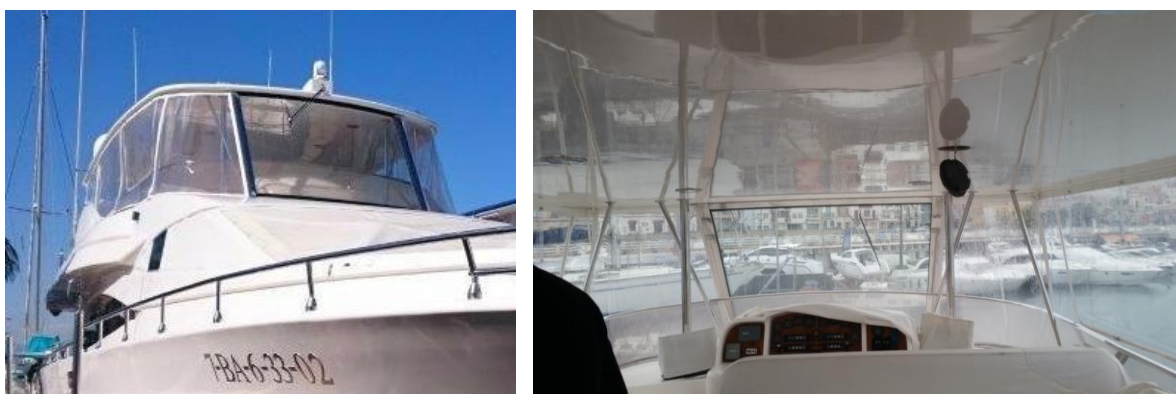
Fig. 3. 19. Tancament flybridge (Font: pròpia)
