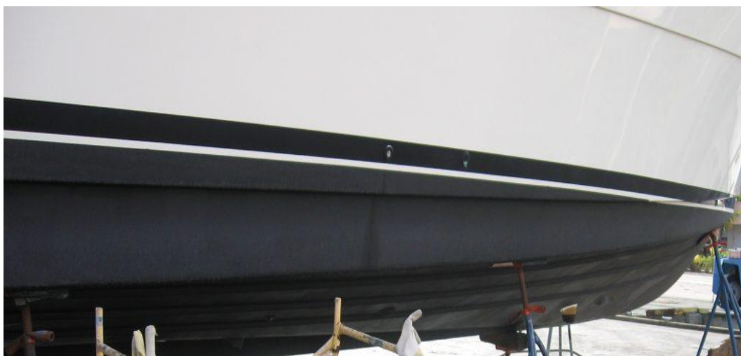
Fig. 4. 144. Pintura antiincrustant (Font: pròpia)
