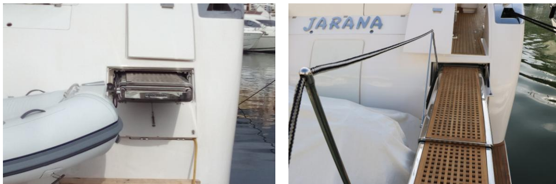
Fig. 4. 53. Passamà de la passarel·la (Font: pròpia)
