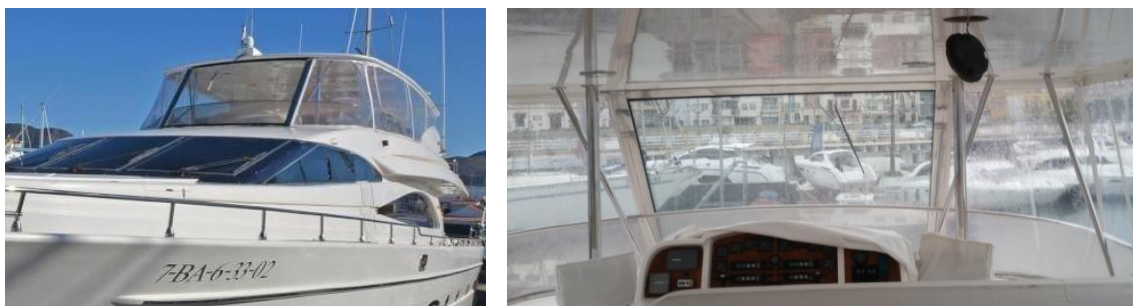
Fig. 4. 37. Tancament Flybridge (Font: pròpia)
